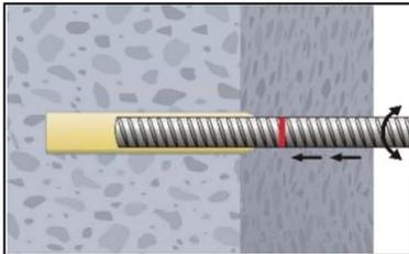
9. Bewehrungsstab mit leichter Drehbewegung bis zur Markierung einführen.
