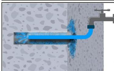
2c. Erneut mit Wasser spülen bis klares Wasser herauskommt. Anschließend stehendes Wasser entfernen.
