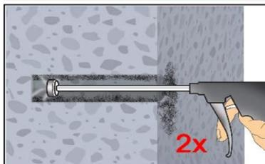
2c. Abschließend Bohrloch mindestens 2x mit Druckluft (min. 6 bar) (Anhang B 6) über die gesamte Verankerungstiefe (ggf. Verlängerung verwenden) ausblasen, bis die ausströmende Luft staubfrei ist.
