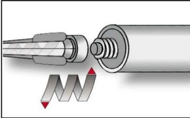
3. Statikmischer SM aufschrauben und Kartusche in geeignetes Auspressgerät einlegen.
