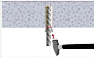
11. Bei Anwendungen in vertikaler Richtung nach oben ist der Bewehrungsstab zu fixieren (z.B. mit Holzkeilen).
