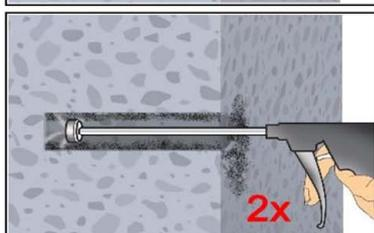
2f. Abschließend Bohrloch mindestens 2x mit Druckluft (min. 6 bar) (Anhang B 6) über die gesamte Verankerungstiefe (ggf. Verlängerung verwenden) ausblasen, bis die ausströmende Luft staubfrei ist.
