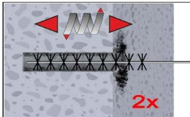
2b. Bohrloch mindestens 2x mit Bürste RB gemäß Tabelle B4 drehend über die gesamte Verankerungstiefe (ggf. Bürstenverlängerung RBL verwenden) ausbürsten.
