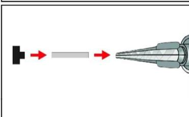
7. Verfüllstutzen VS und Mischerverlängerung VL sind gem. Tabelle B4 oder B5 zu verwenden
