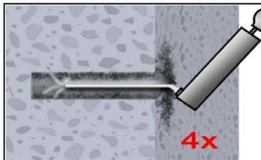
2c. Abschließend Bohrloch vom Bohrlochgrund her mindestens 4x mit einer Handpumpe (Anhang B 6) ausblasen.
