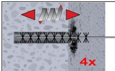
2b. Bohrloch mindestens 4x mit Bürste RB gemäß Tabelle B4 drehend über die gesamte Verankerungstiefe (ggf. Bürstenverlängerung RBL verwenden) ausbürsten.
