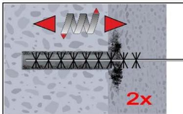
2b. Bohrloch mindestens 2x mit Bürste RB gemäß Tabelle B4 drehend über die gesamte Verankerungstiefe (ggf. RBL verwenden) ausbürsten.
