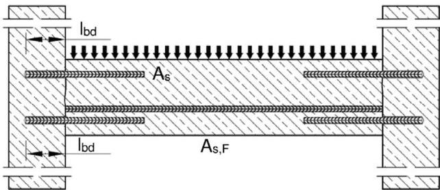
**Bild A4:** Bewehrungsanschlüsse überwiegend auf Druck beanspruchter Bauteile; Bewehrungsstäbe auf Druck beansprucht
