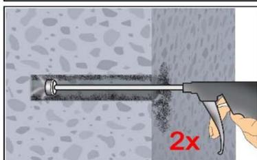
2d. Bohrloch mindestens 2x mit Druckluft (min. 6 bar) (Anhang B 6) über die gesamte Verankerungstiefe (ggf. Verlängerung verwenden) ausblasen, bis die ausströmende Luft staubfrei ist.
