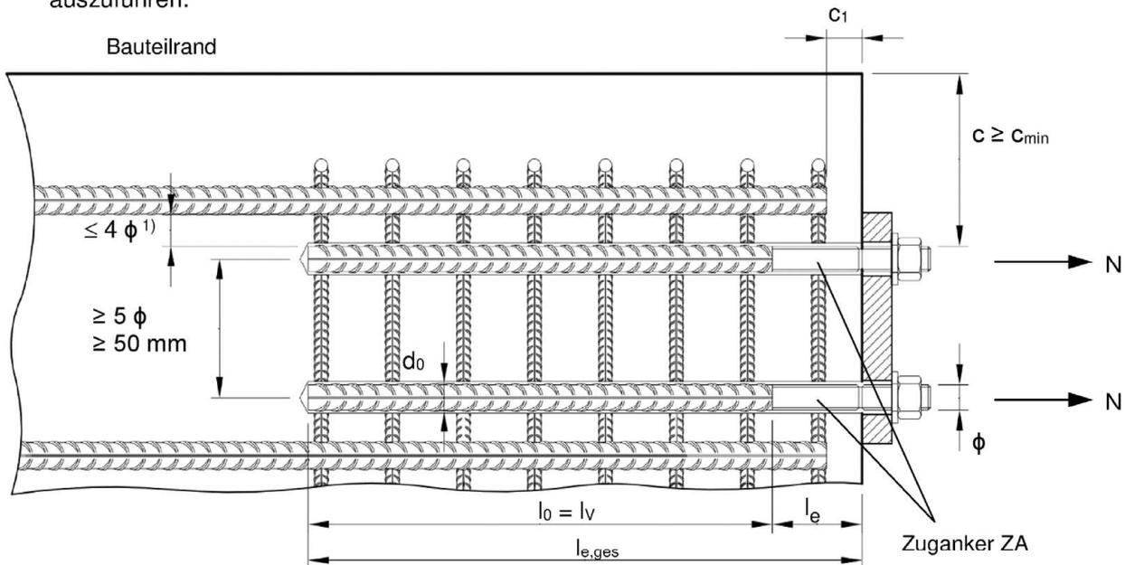
1) Ist der lichte Abstand der gestoßenen Stäbe größer als  $4\phi$ , so muss die Übergreifungslänge um die Differenz zwischen dem vorhandenen lichten Stababstand und  $4\phi$  vergrößert werden.
