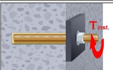
**12.** Anbauteil mit kalibriertem Drehmomentschlüssel montieren. Maximales Montagedrehmoment (Tabelle B1 oder B3) beachten. Bei statischer Vorgabe (z.B. Erdbeben), Ringspalt im Anbauteil mit Mörtel (Anlage A 2) verfüllen. Dazu Unterlegscheibe durch Verfüllscheibe VFS ersetzen und Mischerreduzierung MR verwenden.
