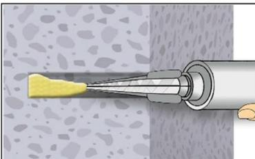
7a. **Injizieren ohne Verfüllstutzen VS:**
