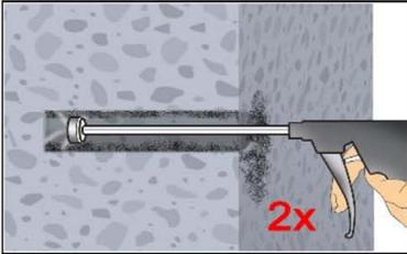
2f. Abschließend Bohrloch mindestens 2x mit Druckluft (min. 6 bar) (Anhang B 4) über die gesamte Verankerungstiefe (ggf. Verlängerung verwenden) ausblasen, bis die ausströmende Luft staubfrei ist.
