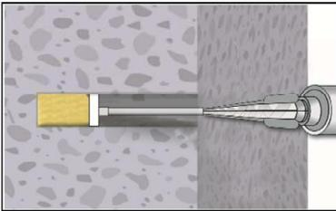
**7b.. Injizieren mit Verfüllstutzen VS:**
