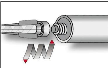
3. Statkmischer SM, aufschrauben und Kartusche in geeignetes Auspressgerät einlegen.
