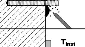
Remove excess mortar.                                                                                                                                                                                                                                                                            |
