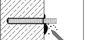
Remove excess mortar.                                                                                                                                                                                                                                                                                                                      |
