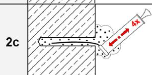
Das Bohrloch vom Bohrlochgrund her erneut mit der Ausblaspumpe mind. **4x** vollständig ausblasen, bis die ausströmende Luft staubfrei ist.
