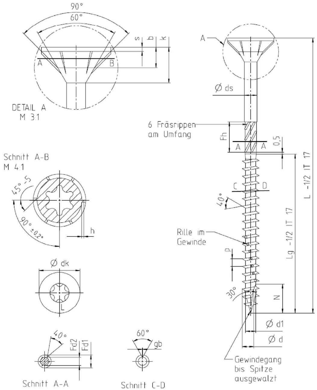
FISHBULL Holzbauschrauben mit Senkkopf und Holzbauschrauben mit Tellerkopf
