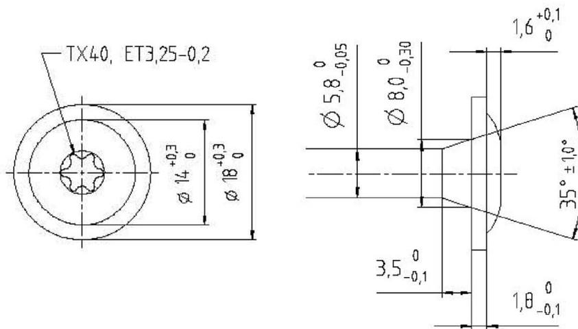
FISHBULL Holzbauschrauben mit Senkkopf und Holzbauschrauben mit Tellerkopf
