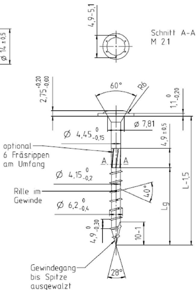
FISHBULL Holzbauschrauben mit Senkkopf und Holzbauschrauben mit Tellerkopf
