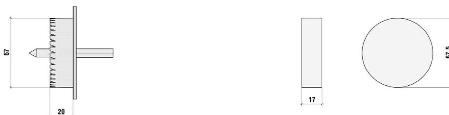
**Spezialwerkzeug WK-FT für die tiefgesetzte Montage Dämmstoffrondelle KS und KSG**
