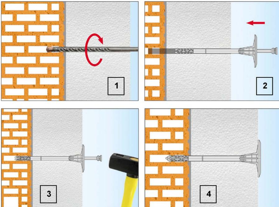
1) Bohrloch senkrecht zur Oberfläche erstellen. Reinigung des Bohrlochs.
