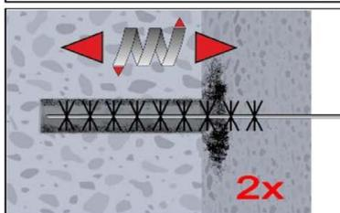
2b. Bohrloch mindestens 2x mit Bürste RB gemäß Tabelle B3 drehend über die gesamte Verankerungstiefe (ggf. Bürstenverlängerung RBL verwenden) ausbürsten.
