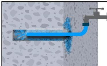
2c. Erneut mit Wasser spülen bis klares Wasser herauskommt. Anschließend stehendes Wasser entfernen.
