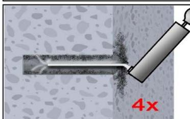
2c. Abschließend Bohrloch vom Bohrlochgrund her mindestens 4x mit einer Handpumpe (Anhang B 4) ausblasen.
