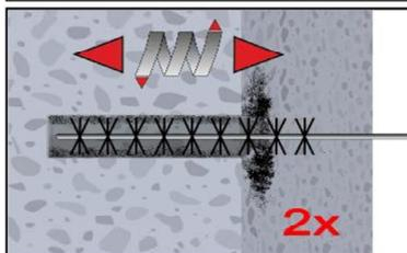
2e. Bohrloch mindestens 2x mit Bürste RB gemäß Tabelle B3 drehend über die gesamte Verankerungstiefe (ggf. Bürstenverlängerung RBL verwenden) ausbürsten.
