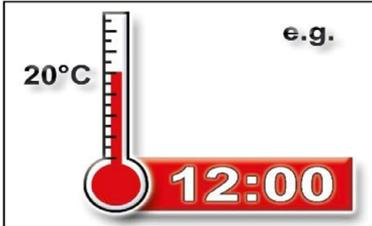
12. Temperaturabhängige Aushärtezeit  $t_{cure}$  (Anhang B 4) muss eingehalten werden. Die Installation der Anschlussbewehrung und der Schalung, darf nach Erreichen der anfänglichen Aushärtezeit  $t_{cure,ini}$  fortgesetzt werden. Die volle Belastung darf erst nach Erreichen der vollen Aushärtezeit  $t_{cure}$  erfolgen.
