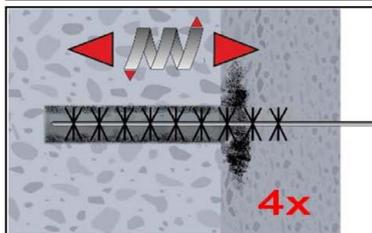
2b. Bohrloch mindestens 4x mit Bürste RB gemäß Tabelle B3 drehend über die gesamte Verankerungstiefe (ggf. Bürstenverlängerung RBL verwenden) ausbürsten.
