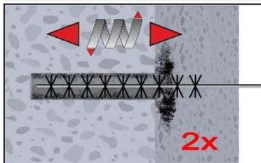
2b. Bohrloch mindestens 2x mit Bürste RB gemäß Tabelle B3 drehend über die gesamte Verankerungstiefe (ggf. RBL verwenden) ausbürsten.
