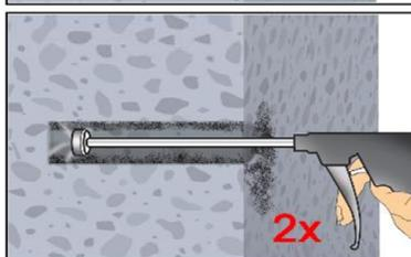
2c. Abschließend Bohrloch mindestens 2x mit Druckluft (min. 6 bar, ölfrei) (Anhang B 4) über die gesamte Verankerungstiefe (ggf. Verlängerung verwenden) ausblasen, bis die ausströmende Luft staubfrei ist.
