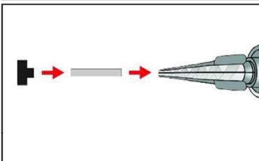
7. Verfüllstutzen VS und Mischerverlängerung VL sind gem. Tabelle B3 oder B4 zu verwenden.
