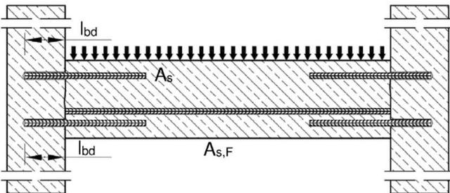
**Bild A4:** Bewehrungsanschlüsse überwiegend auf Druck beanspruchter Bauteile
