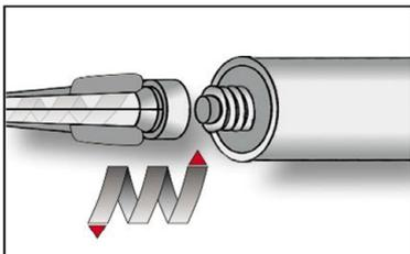
3. Statikmischer SM-14W oder PM-19E, aufschrauben und Kartusche in geeignetes Auspressgerät einlegen. Den Schlauchfolienclip vor der Verwendung abschneiden.
