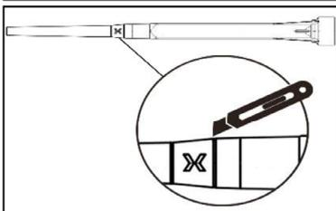
3a. Bei Verwendung der Mischerverlängerung VL16/1,8, muss die Spitze des Mischers PM-19E an der Position „X“ abgeschnitten werden .
