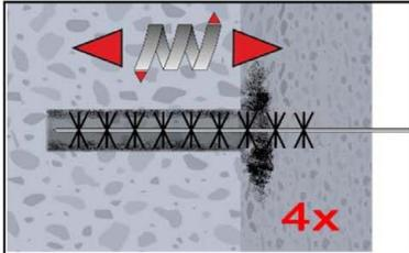
2b. Bohrloch mindestens 4x mit Bürste gemäß Tabelle B3 drehend über die gesamte Verankerungstiefe (ggf. Bürstenverlängerung RBL verwenden) ausbürsten.
