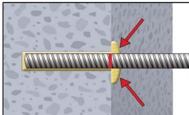
10. Ringspalt zwischen Bewehrungsstab und Verankerungsgrund muss vollständig mit Mörtel gefüllt sein. Andernfalls Anwendung vor Erreichen der maximalen Verarbeitungszeit  $t_{\text{work}}$  ab Schritt 8 wiederholen.
