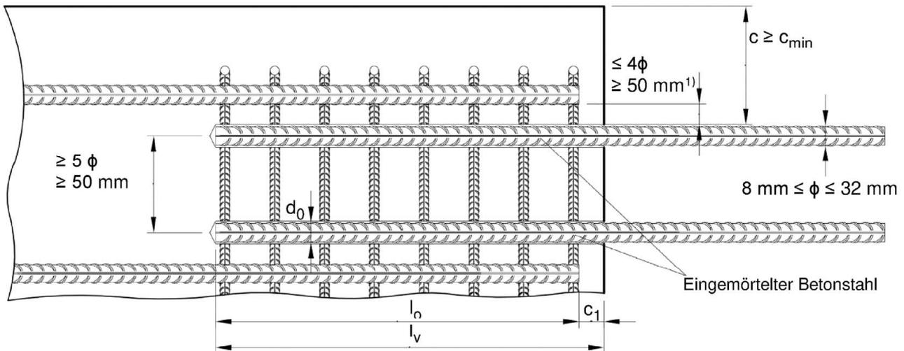
1) Ist der lichte Abstand der gestoßenen Stäbe größer als  $4\phi$  aber mindestens 50 mm, so muss die Übergreifungslänge um die Differenz zwischen dem vorhandenen lichten Abstand und  $4\phi$  aber mindestens 50 mm vergrößert werden.
