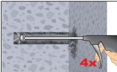
2c. Abschließend Bohrloch mindestens 4x mit Druckluft (min. 6 bar) (Anhang B 5) über die gesamte Verankerungstiefe (ggf. Verlängerung verwenden) ausblasen, bis die ausströmende Luft staubfrei ist.
