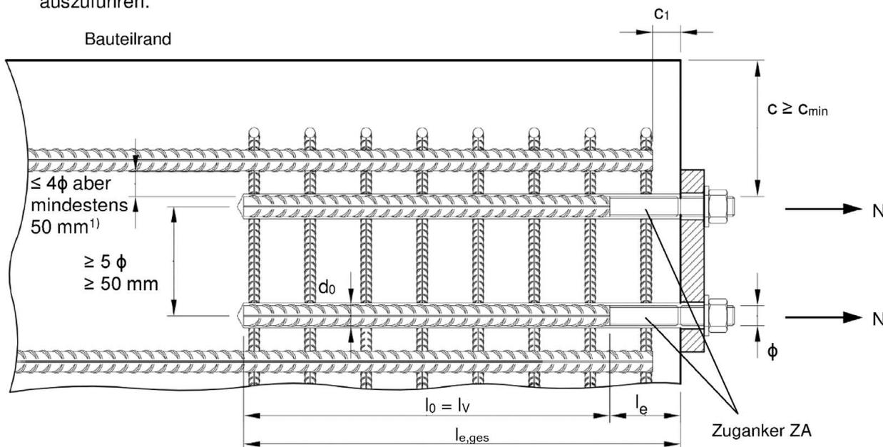
1) Ist der lichte Abstand der gestoßenen Stäbe größer als  $4\phi$  aber mindestens 50 mm, so muss die Übergreifungslänge um die Differenz zwischen dem vorhandenen lichten Abstand und  $4\phi$  aber mindestens 50 mm vergrößert werden
