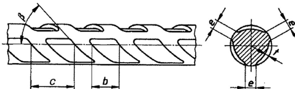
Betonstahl in Ringen B500B kaltverformt mit 3 Reihen Schrägrippen (Tiefrippung) und Werkkennzeichen (WKZ) 2-22 durch verbreiterte Dellen in einer von 3 Reihen:
