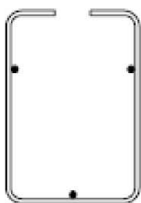
Bild 3: Bügelkorb für \Delta\sigma_{Rsk} = 85 \text{ MPa} (bei N=1\cdot 10^5 Lastzyklen)
