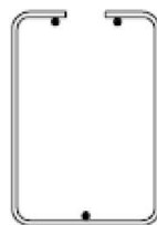
Bild 4: Bügelkorb für \Delta\sigma_{Rsk} = 175 \text{ MPa} (bei N=1\cdot 10^6 Lastzyklen)
