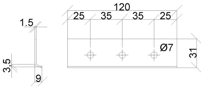
**Lastverteiler L = 200 mm:**  $t = 1,5 \text{ mm} \pm 0,09 \text{ mm}$
