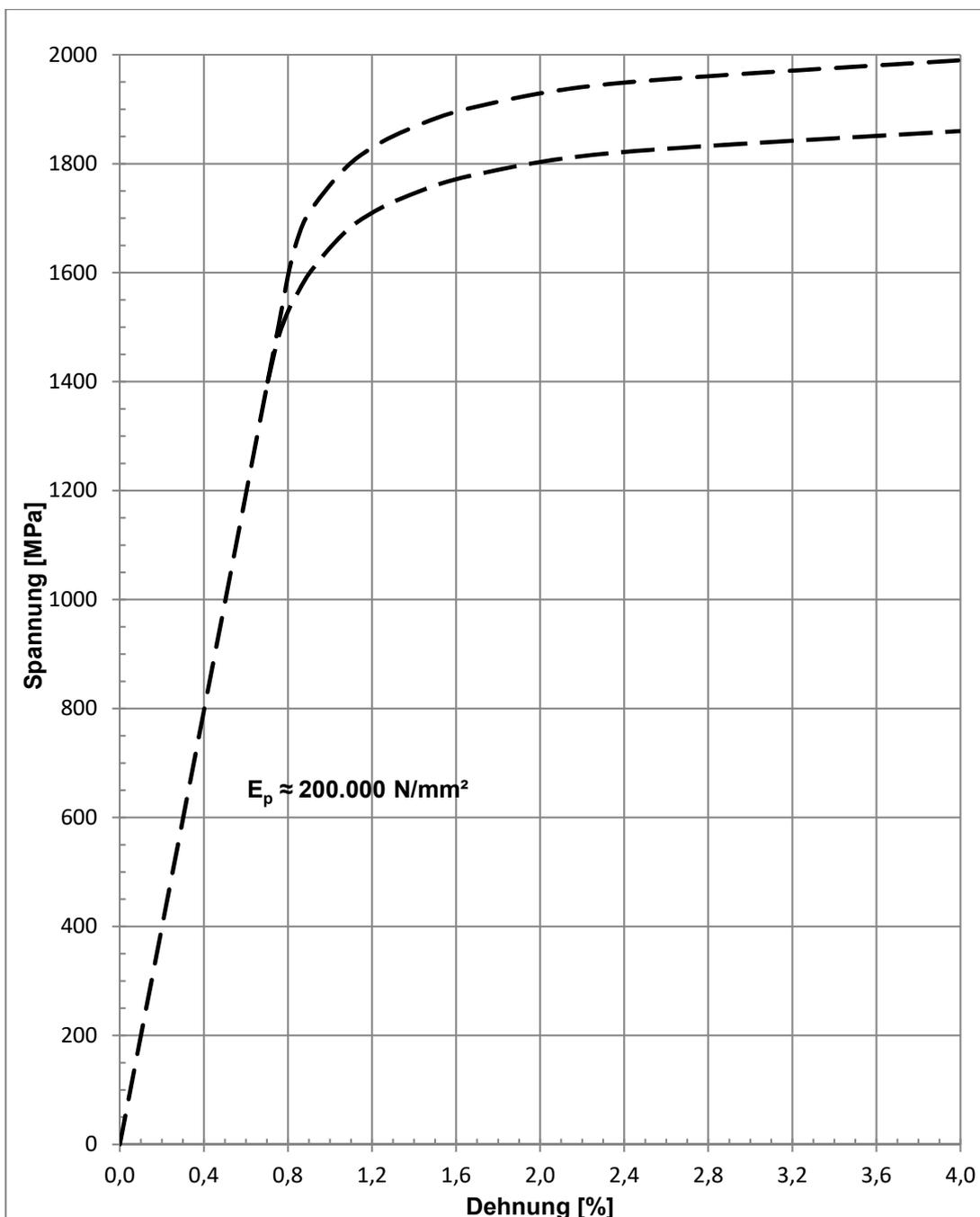
Die Linien geben eine Orientierung für den prinzipiellen Spannungs-Dehnungs-Verlauf bei Annahme des Rechenwertes des E-Moduls ( $E_p$ ) von 200.000 N/mm<sup>2</sup>.
