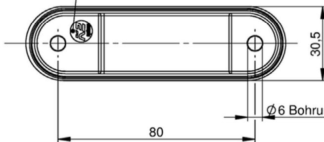
$\varnothing 6$  Bohrung für Bohrschraube / Fließbohrschraube
