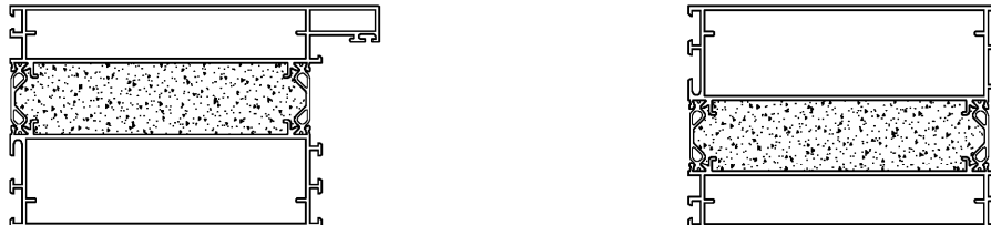
Rahmen-/ Sprossen- und Verbreiterungsprofile (geschäumte Profile 201xx) * mit zusätzlichen Kühlplatten (heroyal 20470 - 20499) - Ausbaustufe 1 20128 20178
