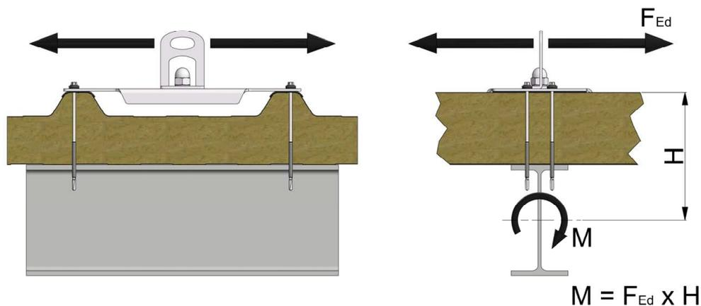
**Abbildung 4 - Einwirkungen für die Unterkonstruktion für Lastfall Absturz (Beispiel)**
