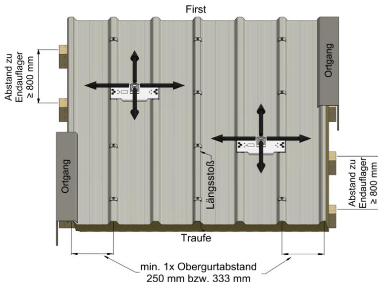
Abbildung 2 - Montagevorgaben für die Planung der Anschlageneinrichtungen
