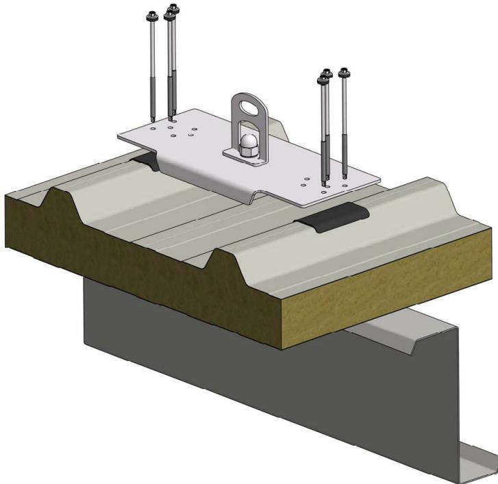
**Abbildung 5 - Abdichtung Anschlagereinrichtung zu Sandwichelement**
