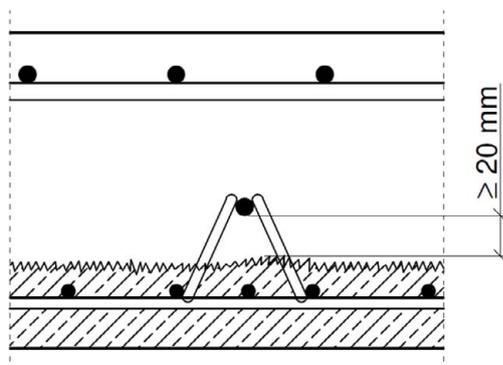
**Bild 6: Gitterträger als Verbund- und Querkraftbewehrung (mäßige Beanspruchung)**
