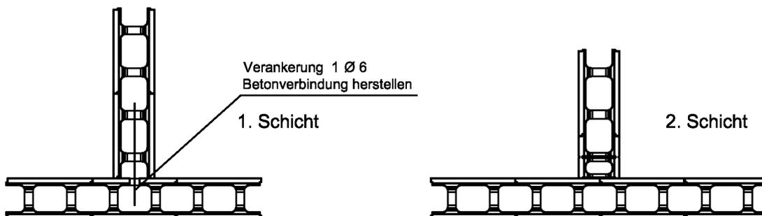
Wandbauart mit Schalungssteinen "SB Schalenbaustein" aus haufwerksporigem Leichtbeton (Typen SB, SBS, SBW und SBWS)
