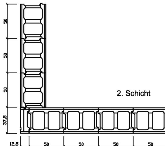
Wandbauart mit Schalungssteinen "SB Schalenbaustein" aus haufwerksporigem
