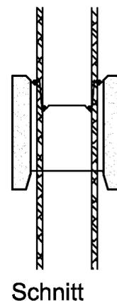
Wandbauart mit Schalungssteinen "SB Schalenbaustein" aus haufwerksporigem Leichtbeton (Typen SB, SBS, SBW und SBWS)
