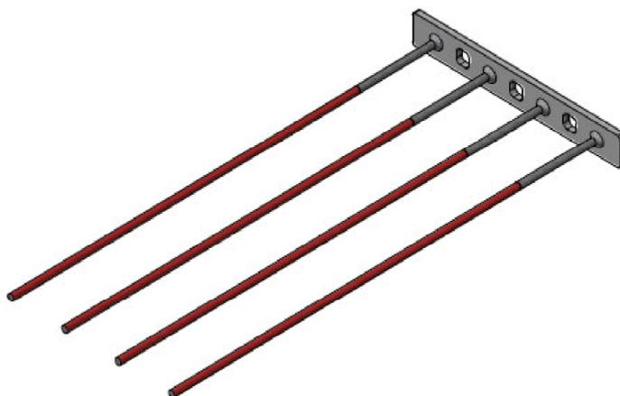
Bild 16: Zugstabplatte mit Zugstäben
