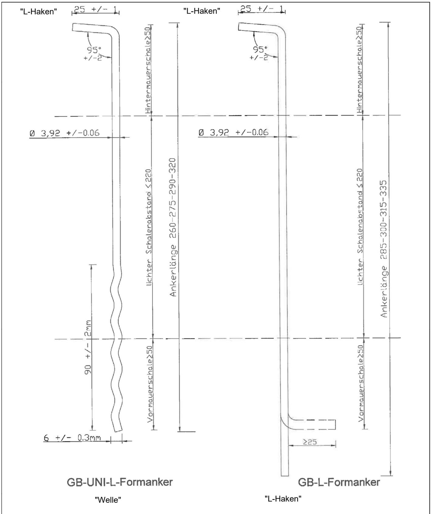
Drahtanker mit Durchmesser 4 mm - bezeichnet als GB-UNI-L- und GB-L-Formanker - für zweischaliges Mauerwerk mit Schalenabständen bis 200 mm
