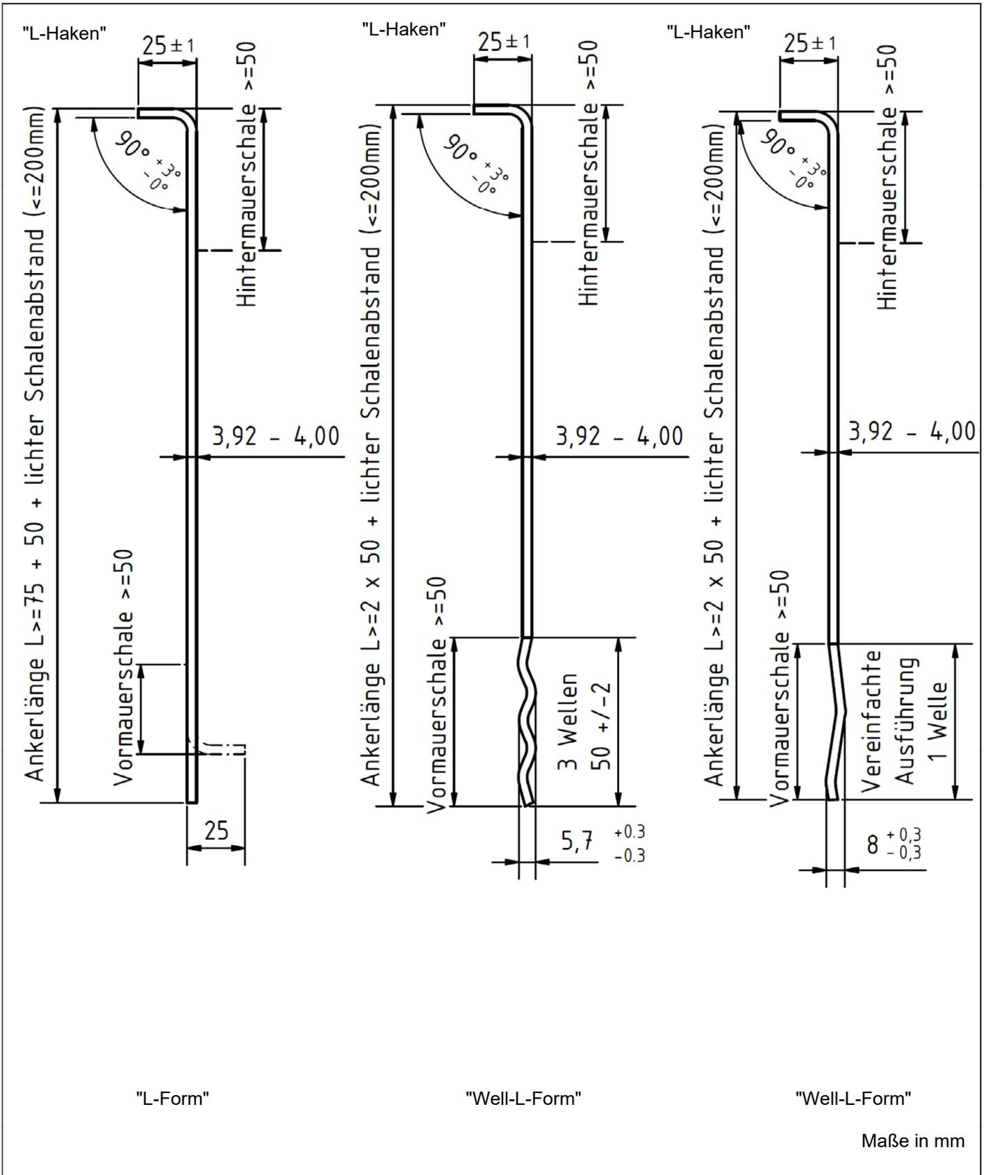
Drahtanker mit Durchmesser 4 mm für zweischaliges Mauerwerk mit Schalenabständen bis 200 mm
