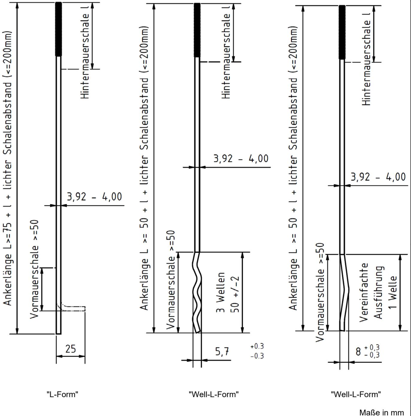
Drahtanker mit Durchmesser 4 mm für zweischaliges Mauerwerk mit Schalenabständen bis 200 mm
