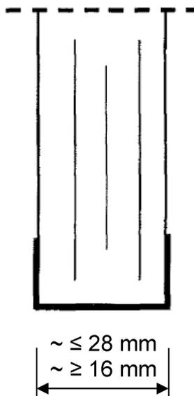
Brandschutz-Verbund-Sicherheitsglas, bestehend aus Floatglasscheiben mit zwischen liegenden Funktionsschichten.
