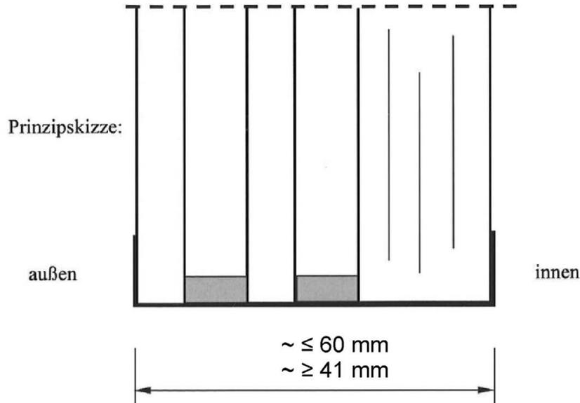
Brandschutzisolierglas, bestehend aus Verbund-Sicherheitsglas aus Floatglasscheiben mit zwischen liegenden Funktionsschichten sowie vorgesetzter Mittelscheibe und Gegen-/Außenscheibe.
