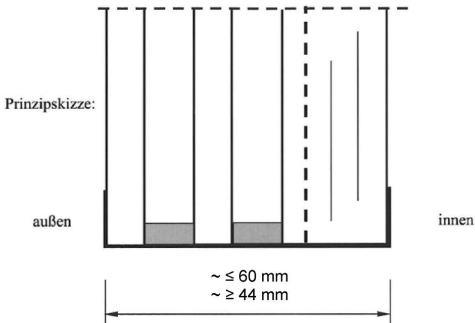
Brandschutzisoliervglas, bestehend aus Verbund-Sicherheitsglas aus Floatglasscheiben mit zwischen liegenden Funktionsschichten und PVB-Folie sowie vorgesetzter Mittelscheibe und Außenscheibe.
