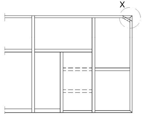
Eckverbinder wird mit Al-Profil verklebt
