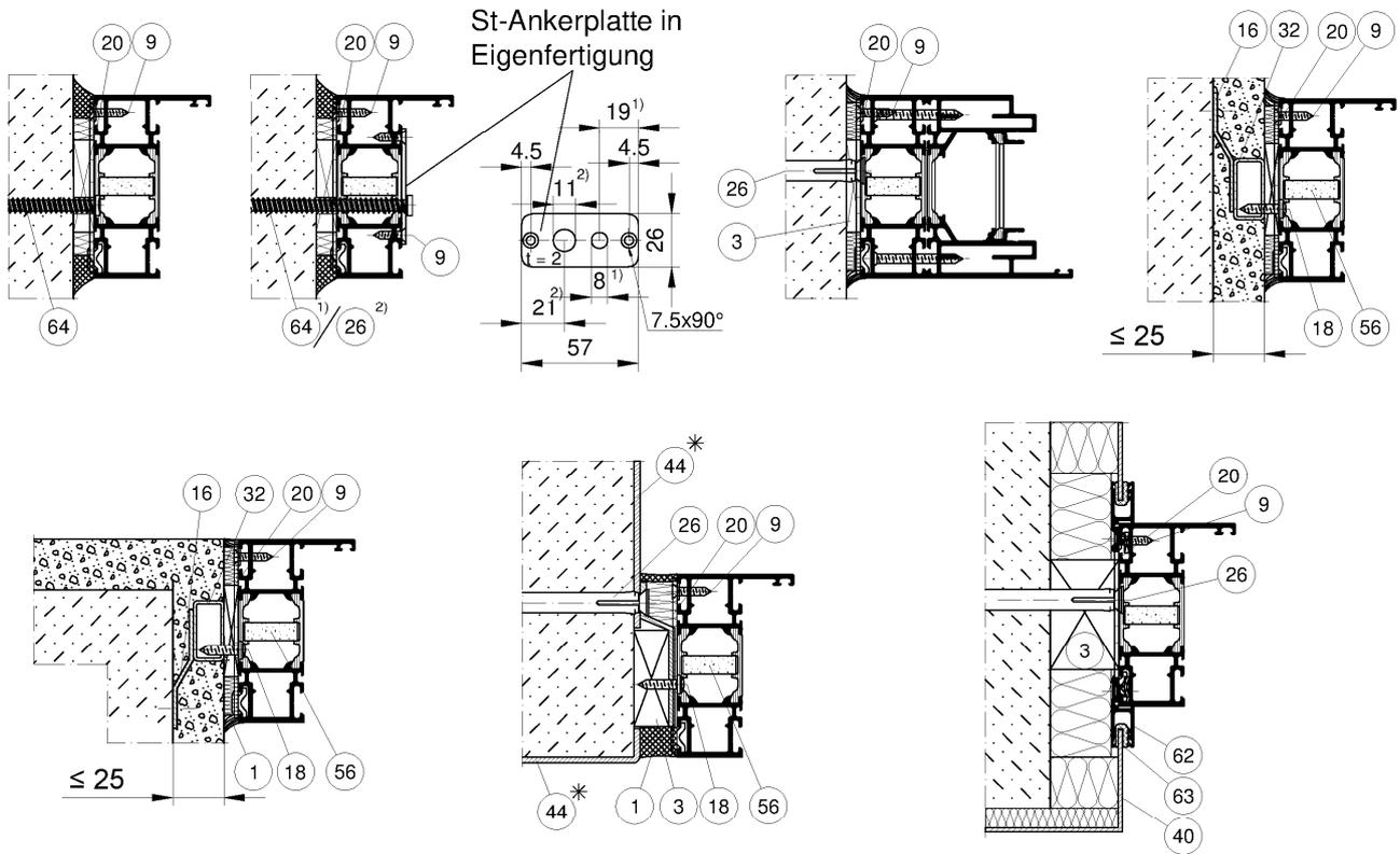
\* Die hier dargestellten Stahlrohre / Stahlwinkel sind Mindestmaße. Abweichend können größere Abmessungen verwendet werden.
