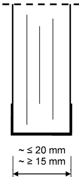
Brandschutz-Verbund-Sicherheitsglas, bestehend aus Floatglasscheiben mit zwischen liegenden Funktionsschichten.
