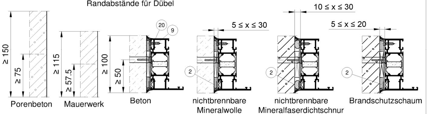
Baukörperanschlüsse im Mauerwerk dargestellt. Analoge Anschlüsse in Porenbeton oder Beton unter Berücksichtigung der Randabstände und geeigneter Befestigungsmittel.
