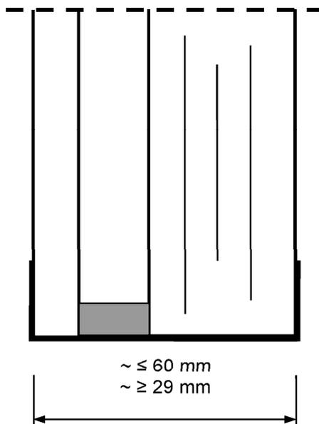
Brandschutzisolierglas, bestehend aus Verbund-Sicherheitsglas aus Floatglasscheiben mit zwischen liegenden Funktionsschichten sowie vorgesetzter Gegen-/Außenscheibe.
