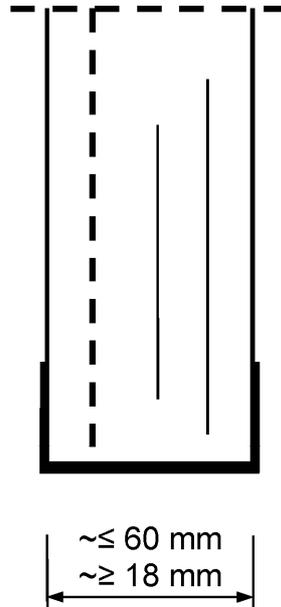
Brandschutz-Verbund-Sicherheitsglas, bestehend aus Floatglasscheiben, mit zwischen liegenden Funktionsschichten und PVB-Folie.
