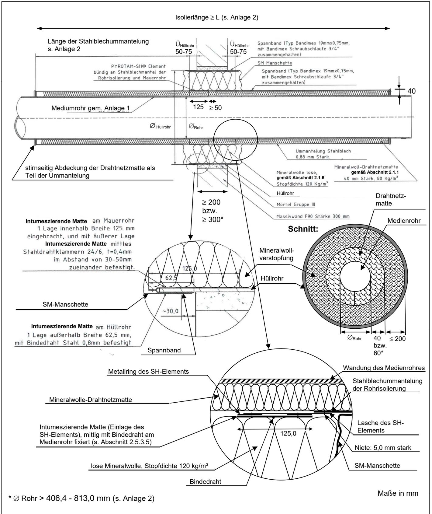
Feuerwiderstandsfähige Abschottung für Rohrleitungen aus Metall "PYROTAM SH"
