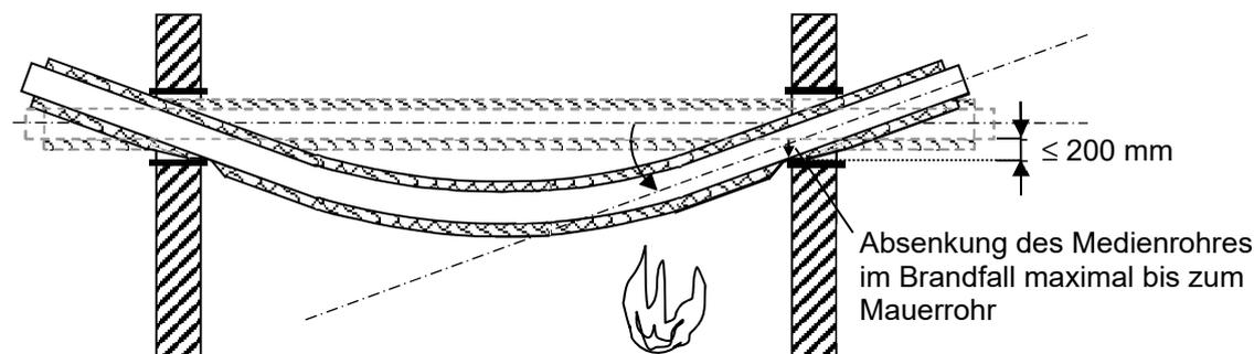
Feuerwiderstandsfähige Abschottung für Rohrleitungen aus Metall "PYROTAM SH"
