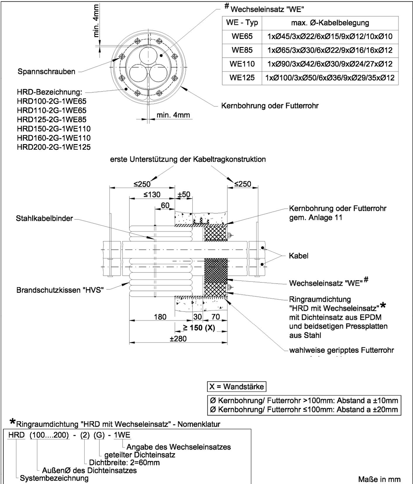
Feuerwiderstandsfähige Abschottung für elektrische Leitungen "Hauff Sicherheitsschott HSS"
