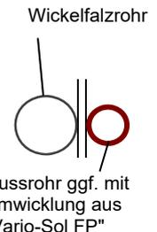
Feuerwiderstandsfähige Abschottung für Rohrleitungen aus Metall mit Anschluss von Rohren aus Kunststoff "System Vario-Sol, Variante 1"
