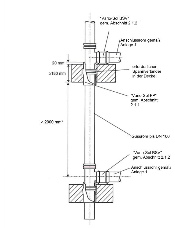
\* bei geringerem Abstand Einbau gemäß Anlage 3 (mit 9 mm dicker Streckenisolierung oberhalb der durchdrungenen Decken)
