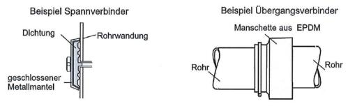
Feuerwiderstandsfähige Abschottung für Rohrleitungen aus Metall mit Anschluss von Rohren aus Kunststoff "System Vario-Sol, Variante 2"
