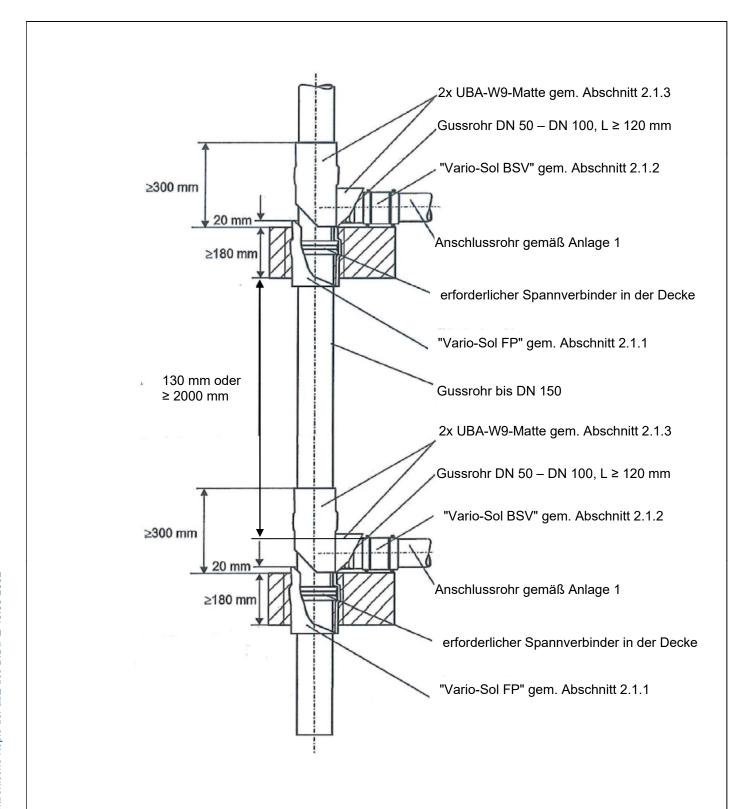
Feuerwiderstandsfähige Abschottung für Rohrleitungen aus Metall mit Anschluss von Rohren aus Kunststoff "System Vario-Sol, Variante 2"
