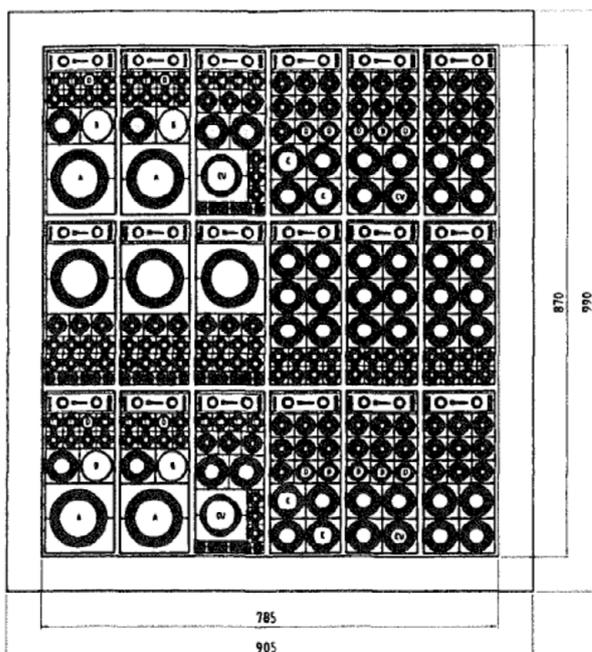
Feuerwiderstandsfähige Abschottung für elektrische Leitungen und Rohrleitungen aus Metall "ROXTEC-System B/G-btb"
