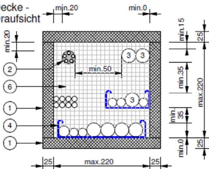
Decke aus Beton oder Porenbeton
