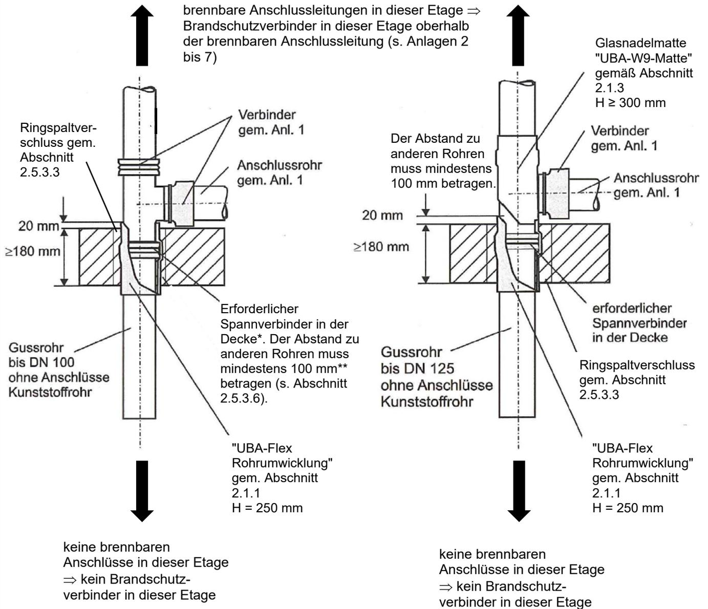
\* Auf den Spannverbinder in der Decke kann verzichtet werden, wenn oberhalb der Decke eine 300 mm lange Umwicklung mit der "UBA-W4-Matte" erfolgt.
