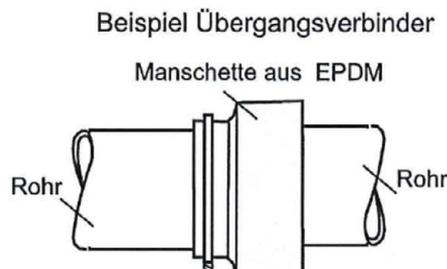
Feuerwiderstandsfähige Abschottung für Rohrleitungen aus Gusseisen mit Anschluss von Rohren aus Kunststoff "System UBA Tec Brandschutzverbinder UBA-BV, Variante 1"
