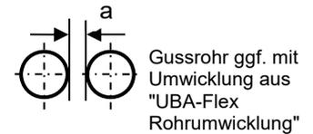
Der Abstand a wird zwischen den Umwicklungen mit dem dämmschichtbildenden Baustoff ("UBA-Flex Rohrumwicklung") im Bereich der Decke gemessen.
