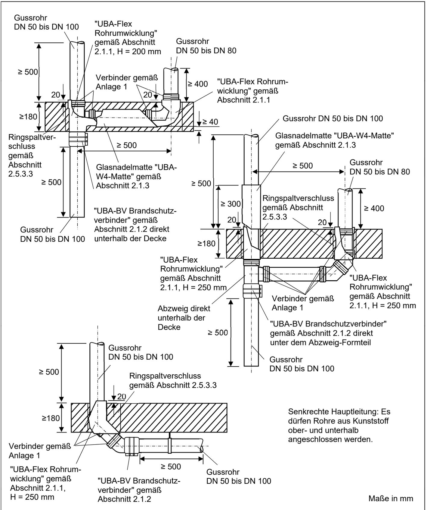
Feuerwiderstandsfähige Abschottung für Rohrleitungen aus Gusseisen mit Anschluss von Rohren aus Kunststoff "System UBA Tec Brandschutzverbinder UBA-BV, Variante 1"
