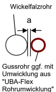
Feuerwiderstandsfähige Abschottung für Rohrleitungen aus Gusseisen mit Anschluss von Rohren aus Kunststoff "System UBA Tec Brandschutzverbinder UBA-BV, Variante 1"
