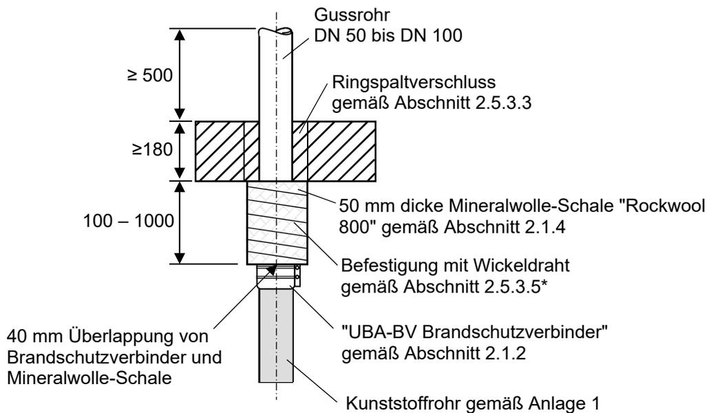
\*erste Umwicklung mit Draht im Abstand  $a \leq 50$  mm zur Decke bzw. zum Ende der Dämmung
