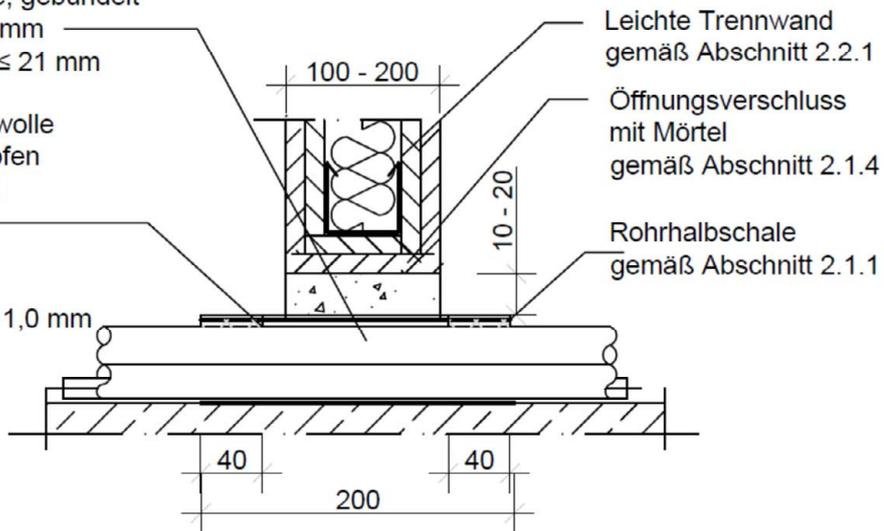
Einbaubeispiel Metallrohre/ Mehrschichtverbundrohre
