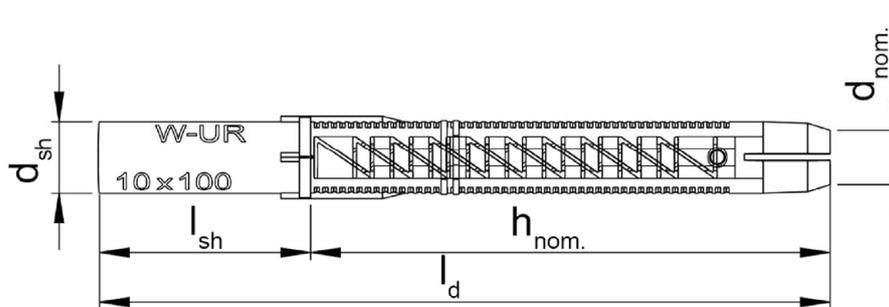
Prägung der Dübelhülse: Dübeltyp, Durchmesser, Länge "W-UR 10x100"
