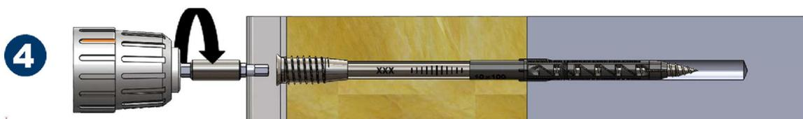
4.) Langsames Eindrehen (ca. 100 U/min) bis die Endposition (Schraubenkopf liegt auf dem
