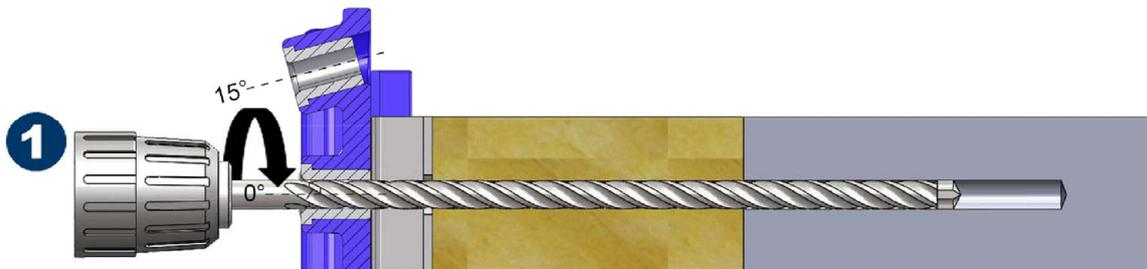
1.) Bohrloch  $\varnothing$  10 mm erstellen durch Profil und Dämmung mit Mindestbohrtiefe im Mauerwerk/
