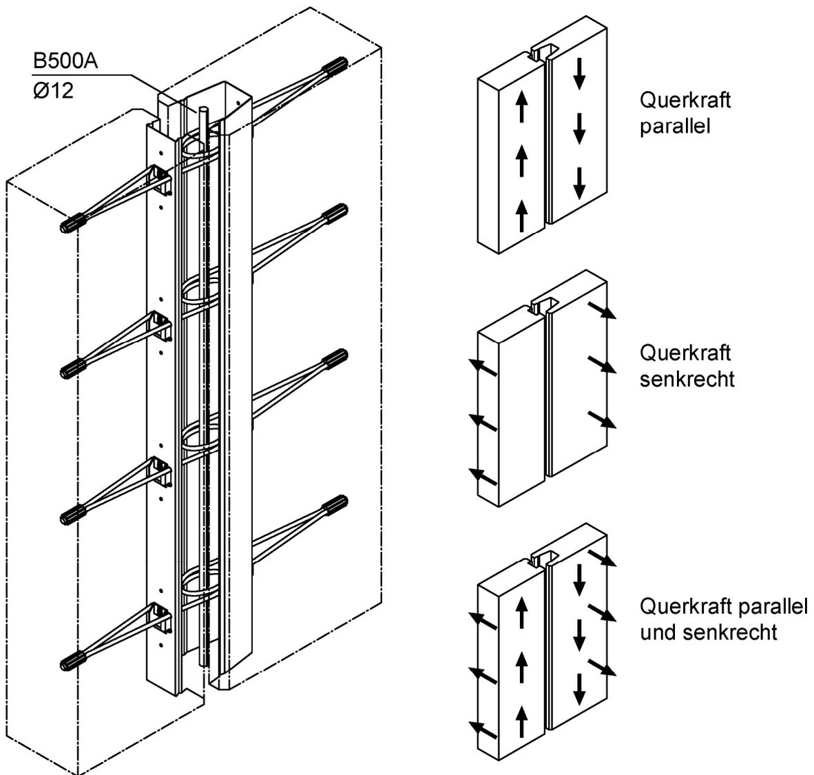
Bild 3: Einbauzustand ohne Fugenverguss und zulässige Belastungsrichtungen
