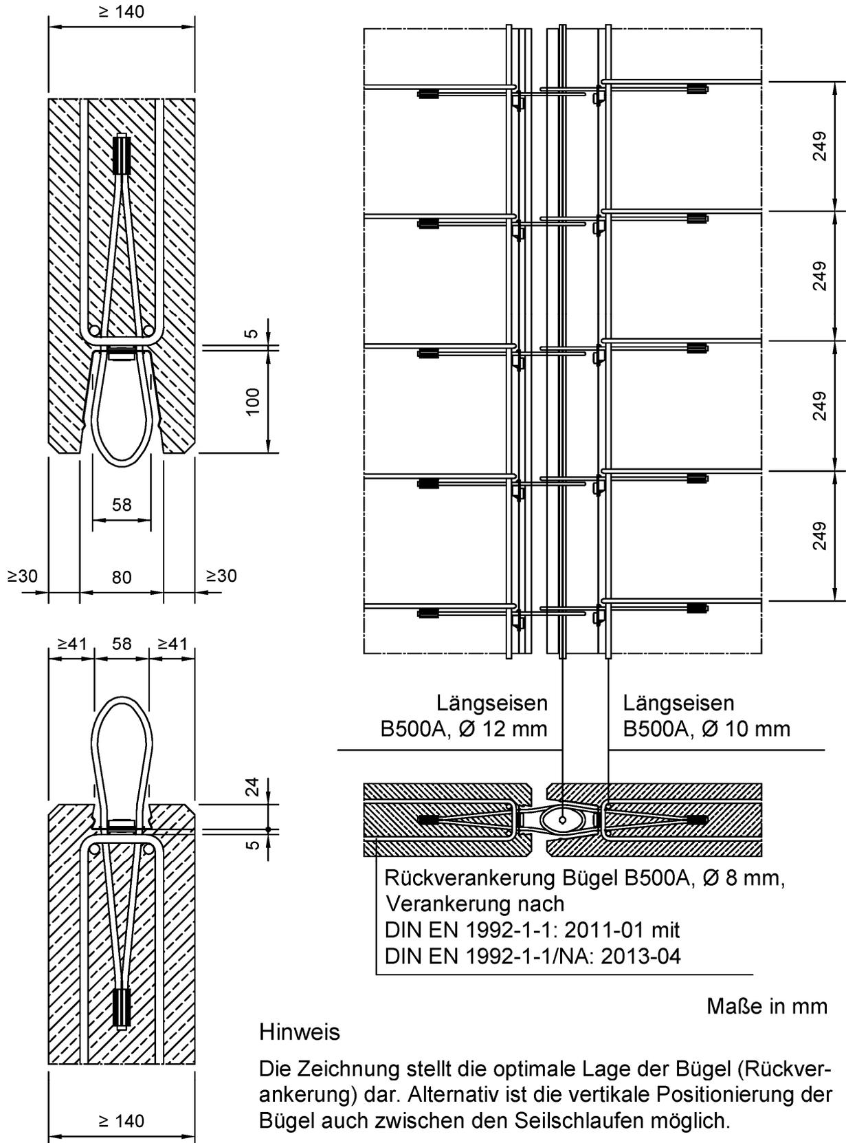
**Halfen Loop Box HLB T 100/250-System zur Verbindung von Stahlbetonfertigteilmwänden**
