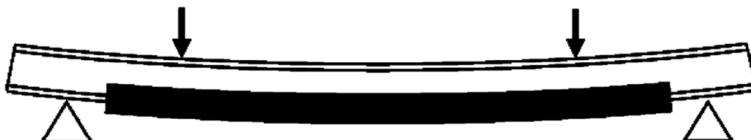
Abb.3: Betonieren des Stahlträger-Untergurtes unter Einwirkung der Einzellasten
