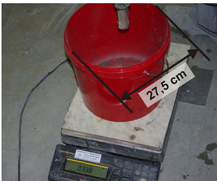
Bild 4: Versuchsanordnung zur Einstellung des Mantelluft-Drucks
