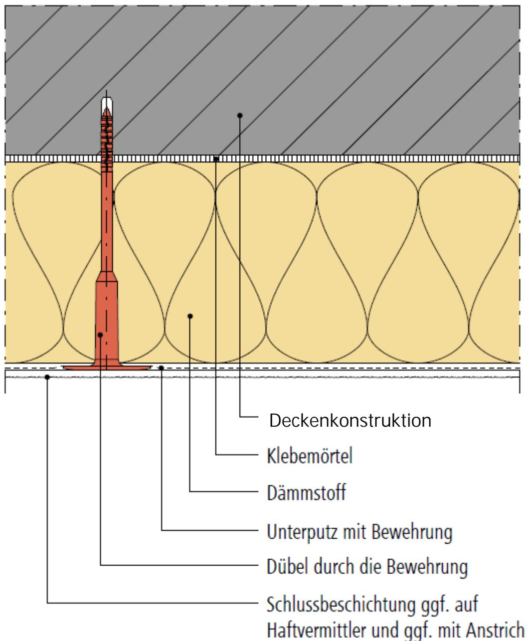
Aufbau des WDVS mit EPS-Platten
