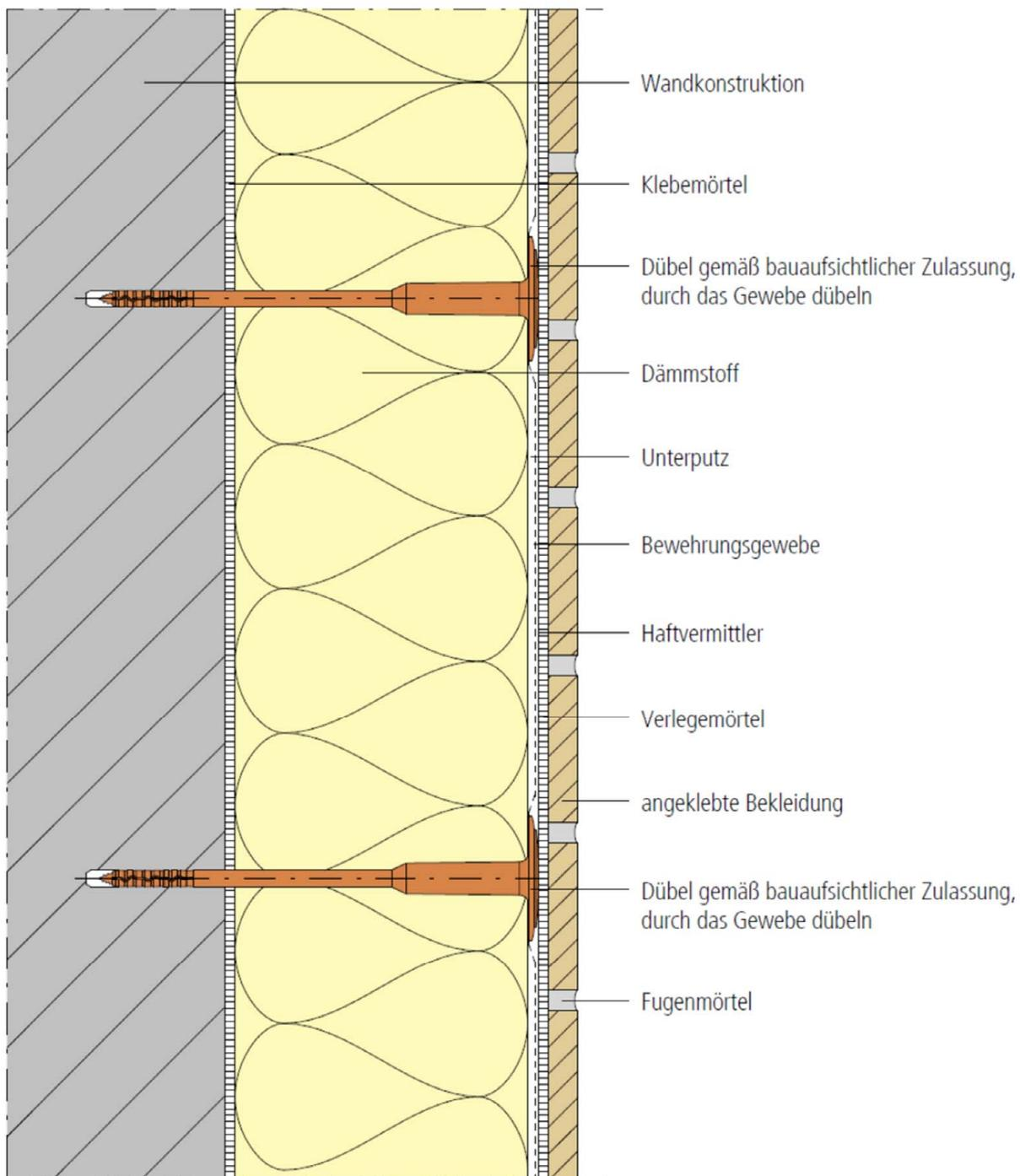
**Aufbau des WDVS mit EPS-Platten
