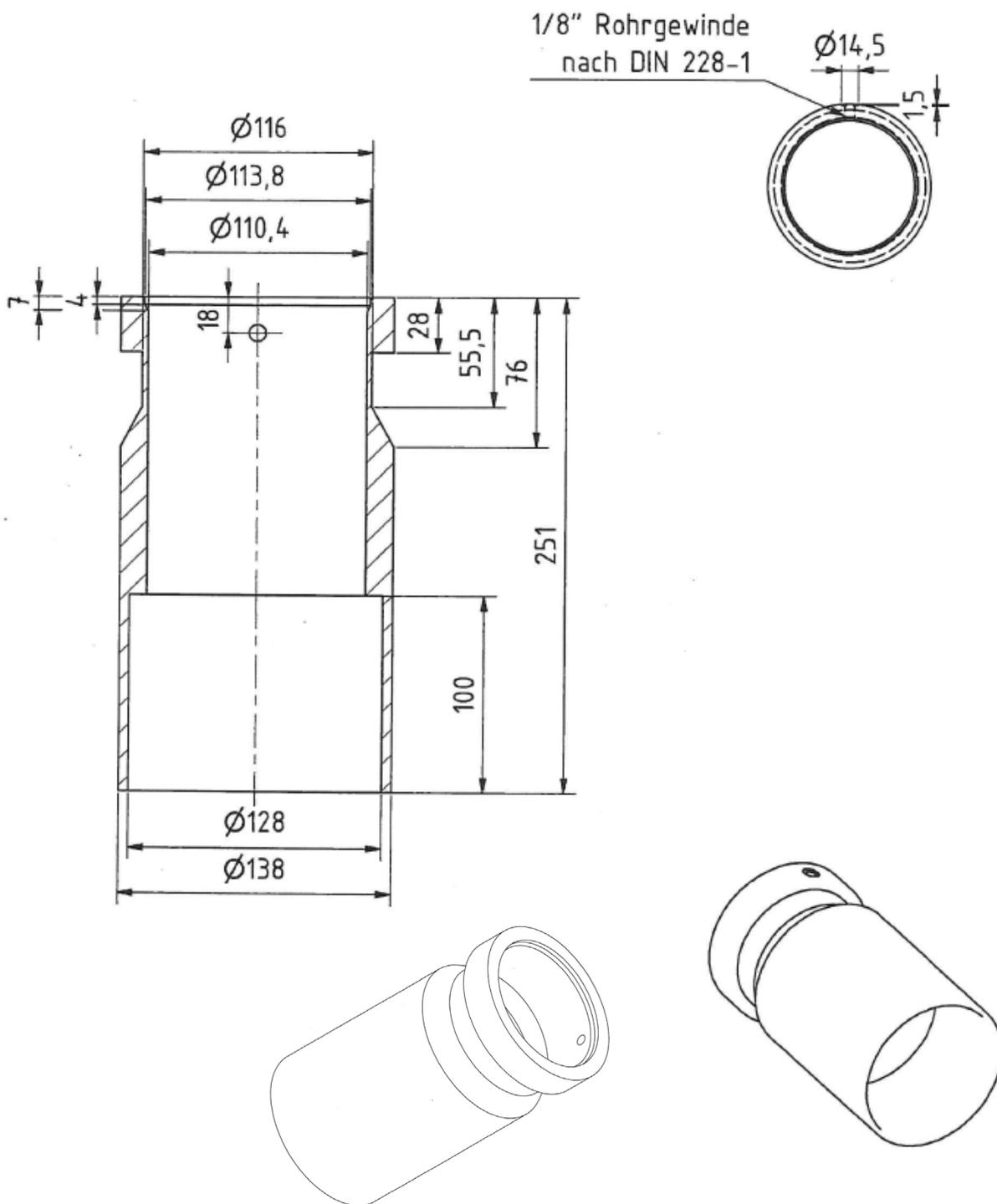
Anschlussverbinder/Reparaturmanschette für Rohrleitungen
