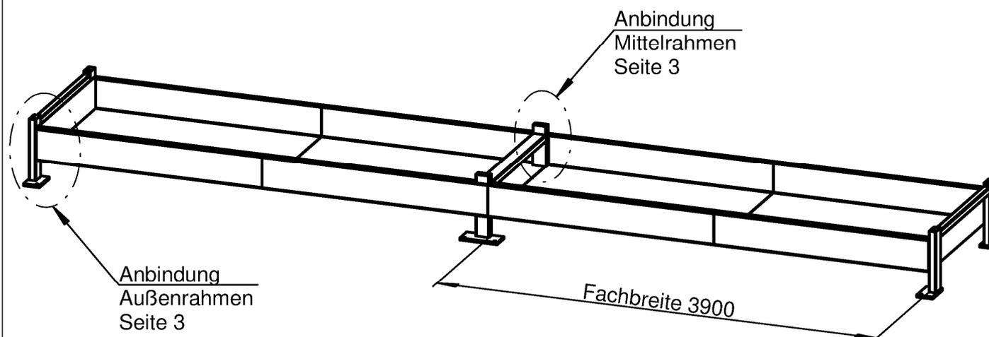
Bei Containervarianten mit nur einer Fachbreite entfällt der Mittelrahmen.
