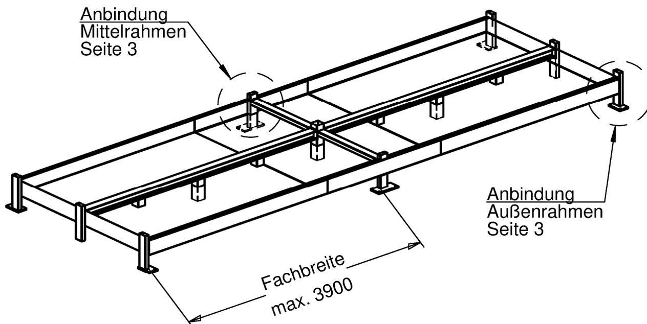
Bei Containervarianten mit nur einer Fachbreite entfällt der Mittelrahmen.
