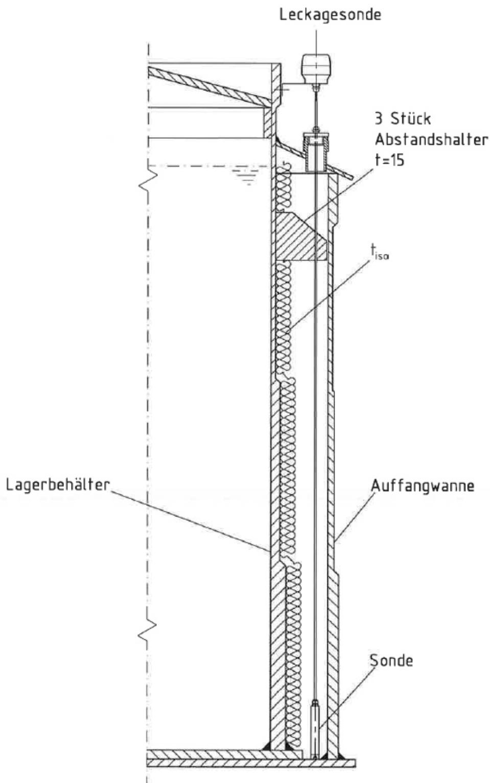
Flachbodenbehälter und Auffangvorrichtungen aus Polyethylen mit gewickelten
