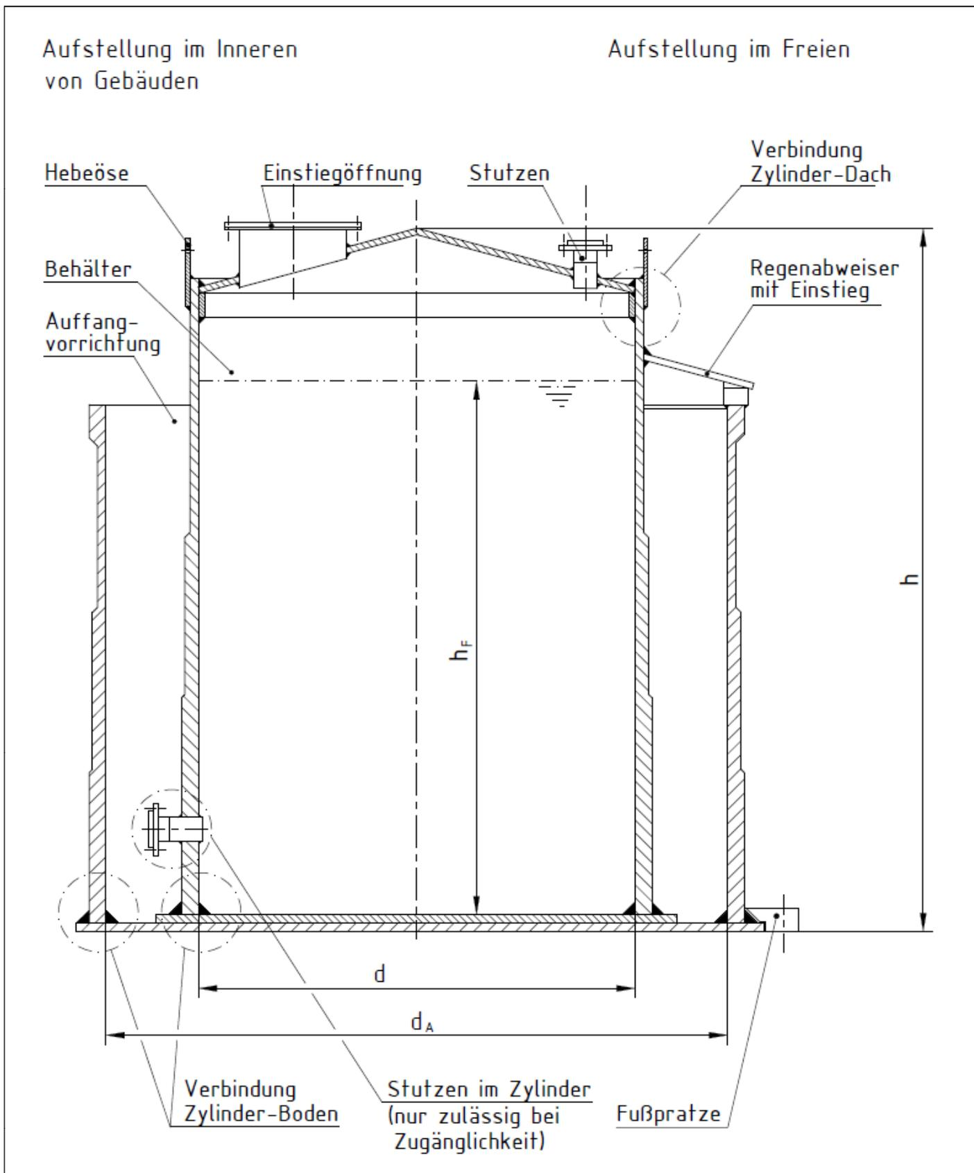
Flachbodenbehälter und Auffangvorrichtungen aus Polyethylen mit gewickelten Zylindermänteln (Wickelrohrbehälter)
