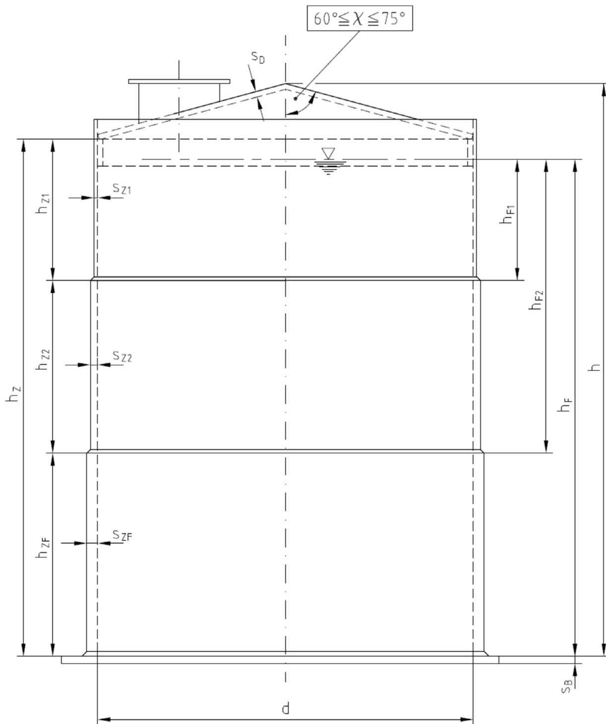
Flachbodenbehälter und Auffangvorrichtungen aus Polyethylen mit gewickelten
