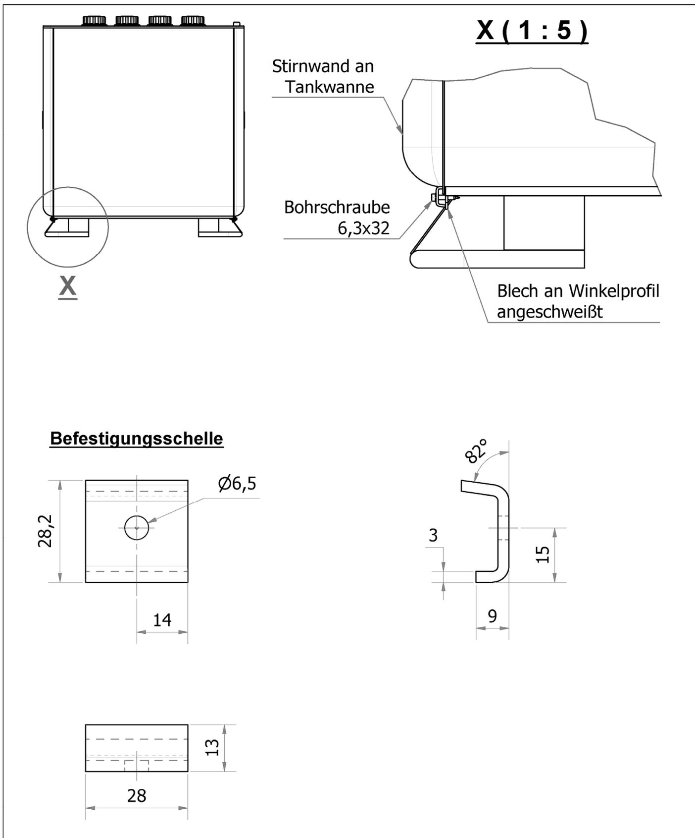
Blasgeformte Behälter aus Polyethylen (PE-HD)
