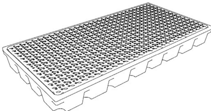
Auffangvorrichtung aus Polyethylen (PE), Typ B
