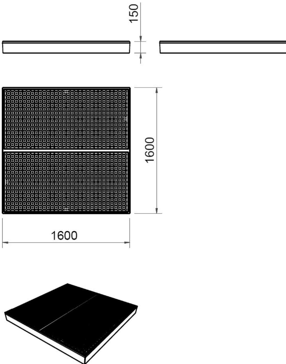
Auffangvorrichtung aus Polyethylen (PE), Typ B
