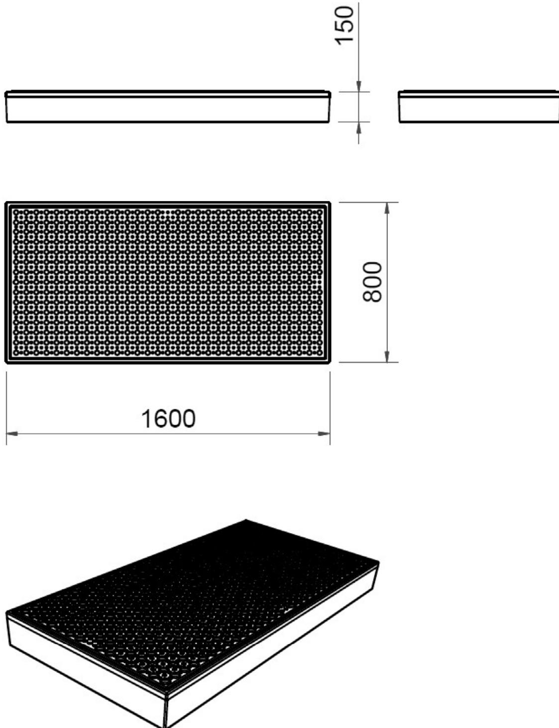
Auffangvorrichtung aus Polyethylen (PE), Typ B
