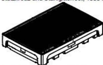
Typ 5 (Doppelstation mit Stützkreuz und Stahlgitterrost, 1000 l)
