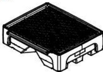
Typ 11 (Erweiterungsauffangwanne mit Stützkreuz und Stahlgitterrost, 500 l)
