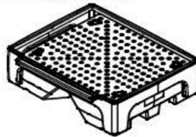
Typ 12 (Erweiterungsauffangwanne mit Stützkreuz und PE-Lochplatte, 500 l)
