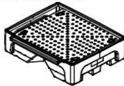
Typ 12 (Erweiterungsauffangwanne mit Stützkreuz und PE-Lochplatte, 500 l)
