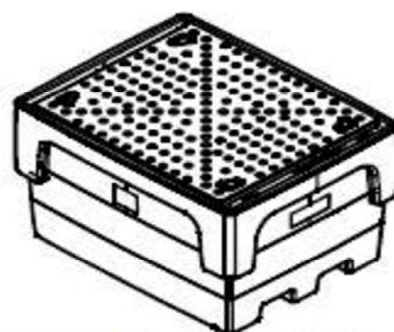
Typ 7 (Einfachstation mit Stützkreuz und PE-Lochplatte, 1000 l)
