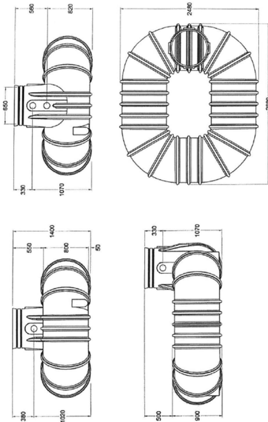
Abflusslose Sammelgrube aus Polyethylen (PE)
