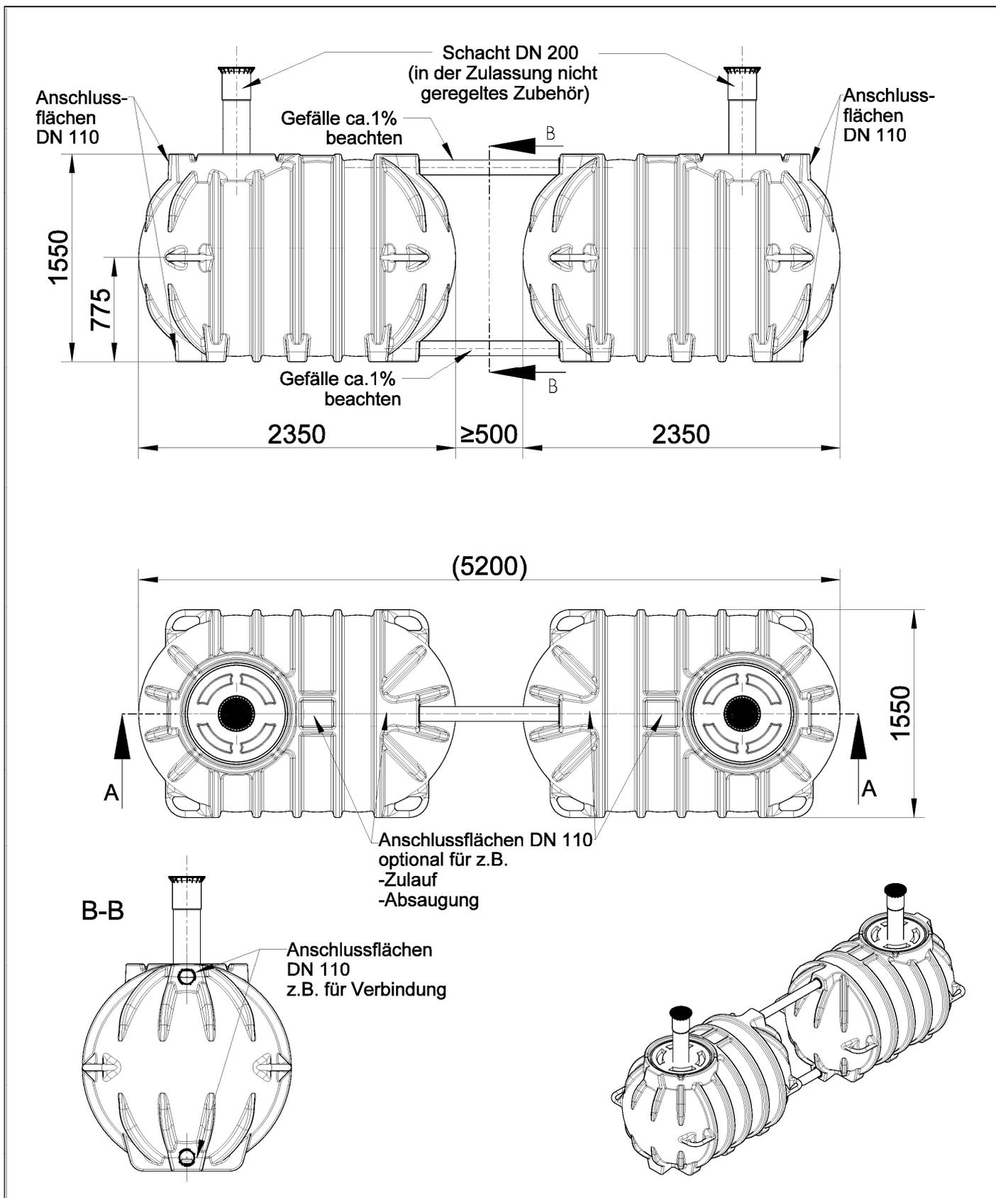
Abflusslose Sammelgruben aus rotationsgeformtem Polyethylen (PE) zur Lagerung von häuslichem Abwasser 2000 l und 3000 l Plus
