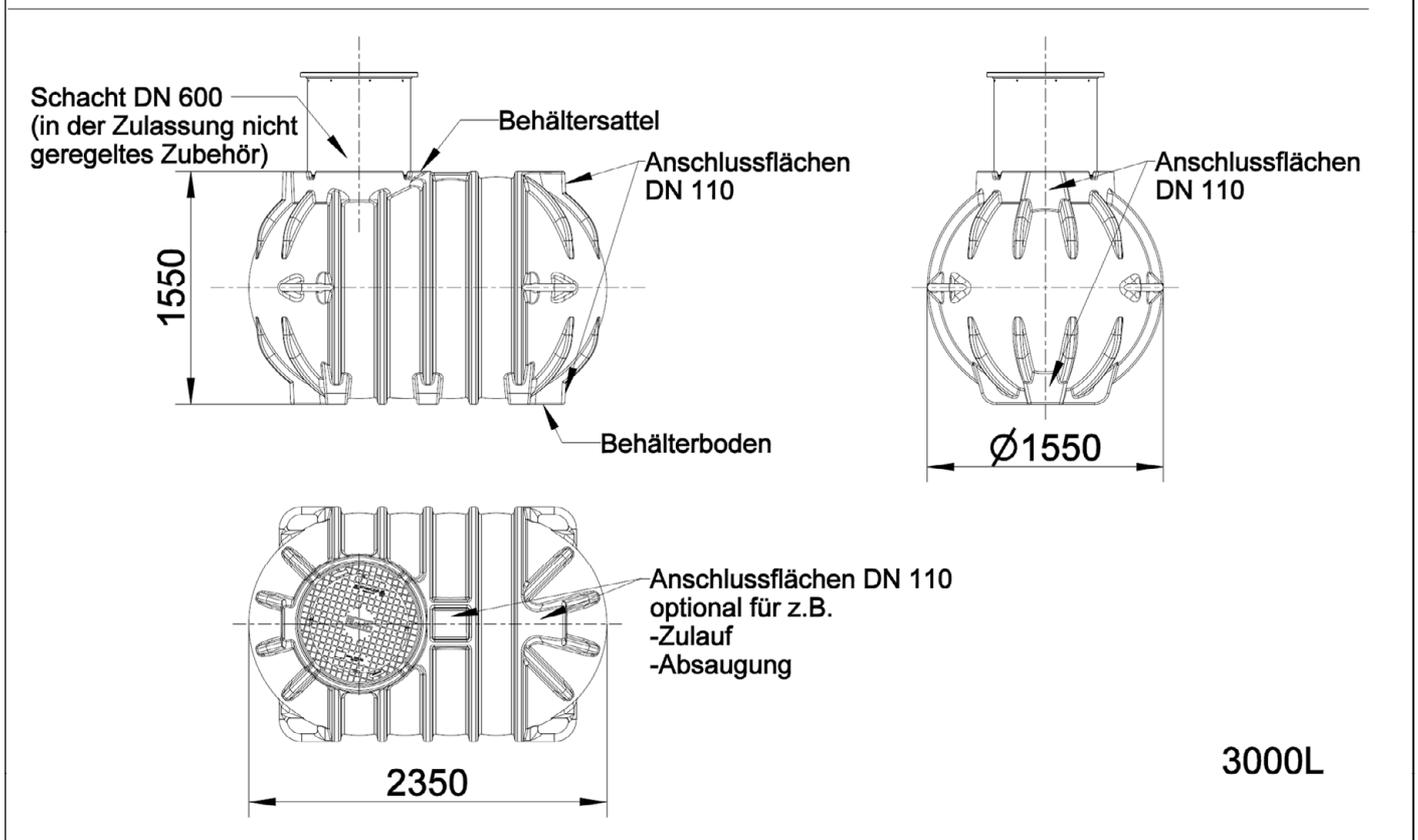
Abflusslose Sammelgruben aus rotationsgeformtem Polyethylen (PE) zur Lagerung von häuslichem Abwasser 2000 l und 3000 l Plus
