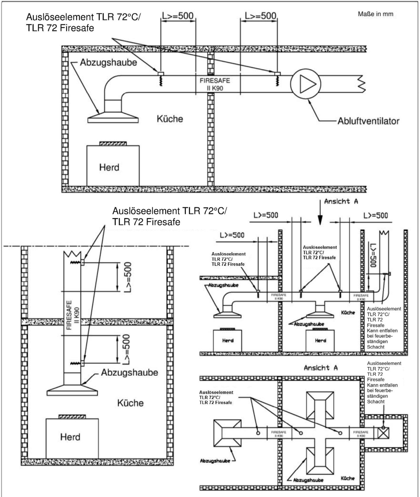
Absperrvorrichtung gegen Feuer und Rauch in Lüftungsleitungen von gewerblichen Küchen, Typ "Firesafe II K90"
