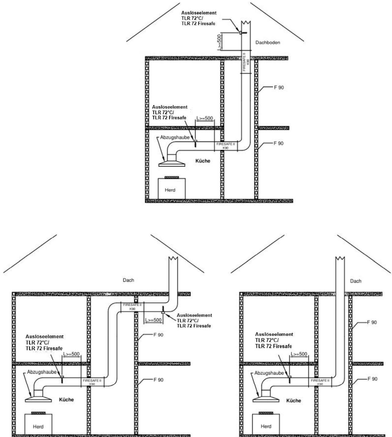
Absperrvorrichtung gegen Feuer und Rauch in Lüftungsleitungen von gewerblichen
