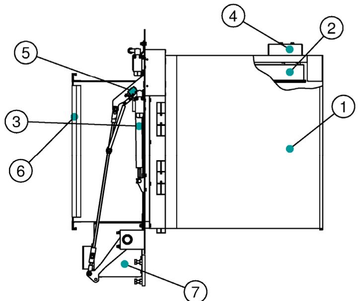
Absperrvorrichtung gegen Feuer und Rauch in Lüftungsleitungen von gewerblichen Küchen, Typ "Firesafe II K90"
