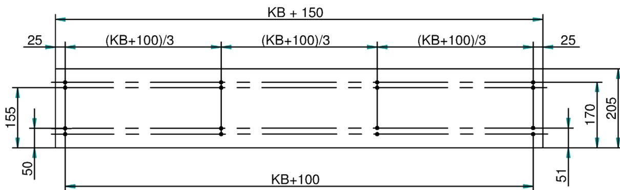
Befestigungspaket mittels verzinktem Stahlblech und gips- oder zementgebundene Bauplatten im gegenseitigen Wechsel erstellen. Zum verschrauben des Pakets Spanplattenschrauben  $\text{Ø}4 \times 30 \text{mm}$  verwenden. Bei Wanddicken  $> 100 \text{mm}$  das Befestigungspaket um weitere Wechsel verstärken bis das Innenmaß des UA Profils erreicht wurde.
