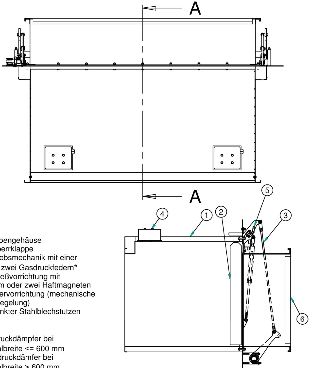
Absperrvorrichtung gegen Feuer und Rauch in Lüftungsleitungen von gewerblichen
