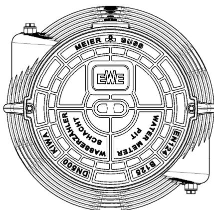
Erdverlegter Kontrollschacht aus rotationsgeformtem Polyethylen (PE-LLD) mit der Bezeichnung "EWE-FLEXORIPP" zur Aufnahme von Wasserzählern und Armaturen
