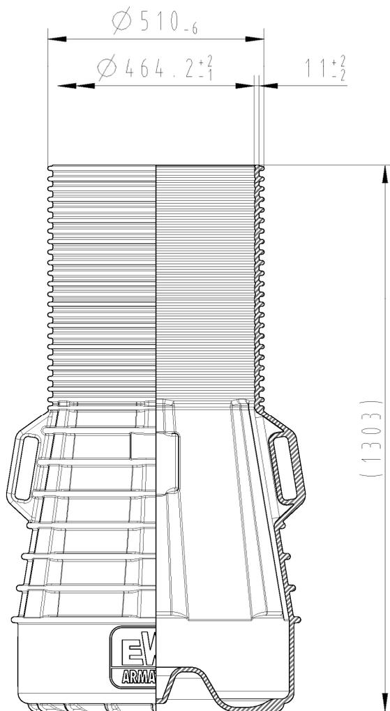
Erdverlegter Kontrollschacht aus rotationsgeformtem Polyethylen (PE-LLD) mit der Bezeichnung "EWE-FLEXORIPP" zur Aufnahme von Wasserzählern und Armaturen
