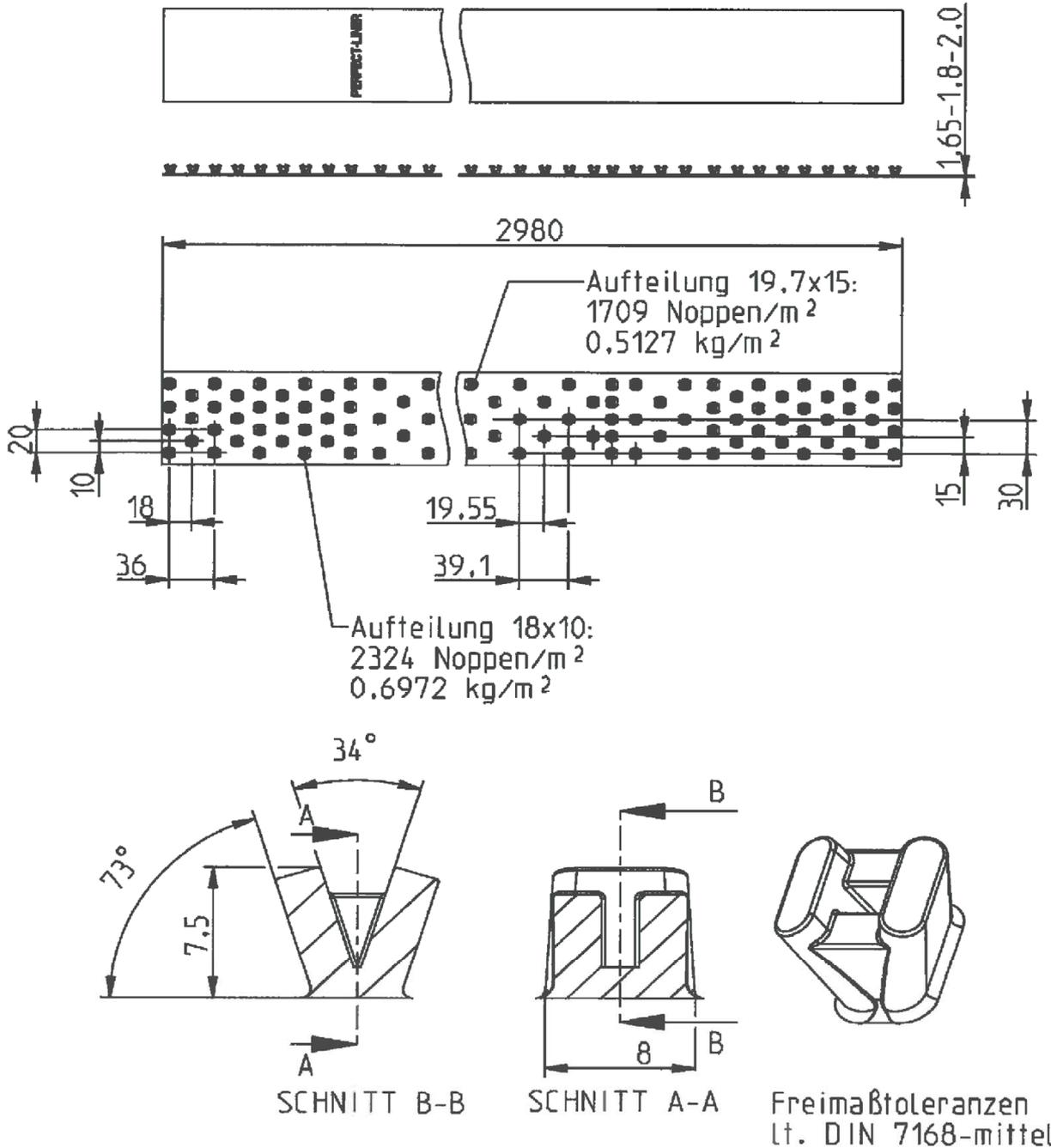
Betonschutzplatten für die Auskleidung von Rohren aus Beton oder Stahlbeton aus PE-HD mit der Bezeichnung "Perfect Liner"
