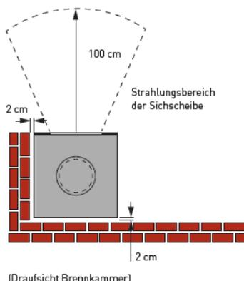
Für »elements« mit oder ohne seitliche Anbauelemente gilt der links gezeigte Sicherheitsabstand zu nicht brennbaren Bauteilen und Wänden (z.B. Beton, Stein, Putz).
