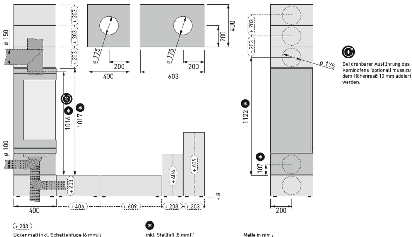
Raumluftunabhängige Einzelraumfeuerstätten mit der Bezeichnung "Elements RLU" in verschiedenen Ausführungsvarianten
