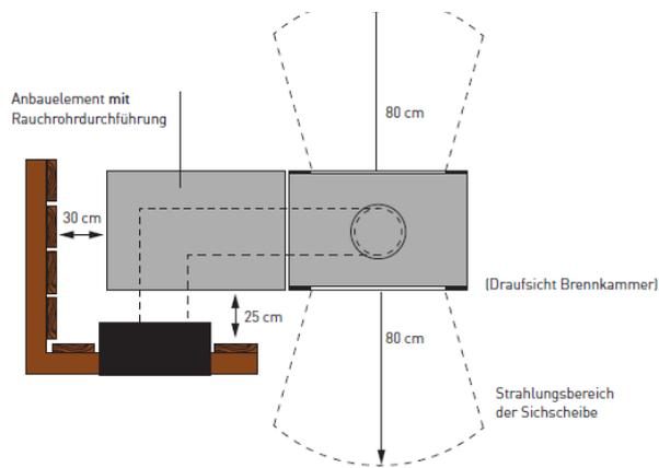
Anbauelemente, durch die Rauchrohre geführt werden, sind mit mindestens 30 cm Abstand zu brennbaren Bauteilen oder Wänden zu installieren (bitte beachten Sie die DIN des Rauchrohres).
