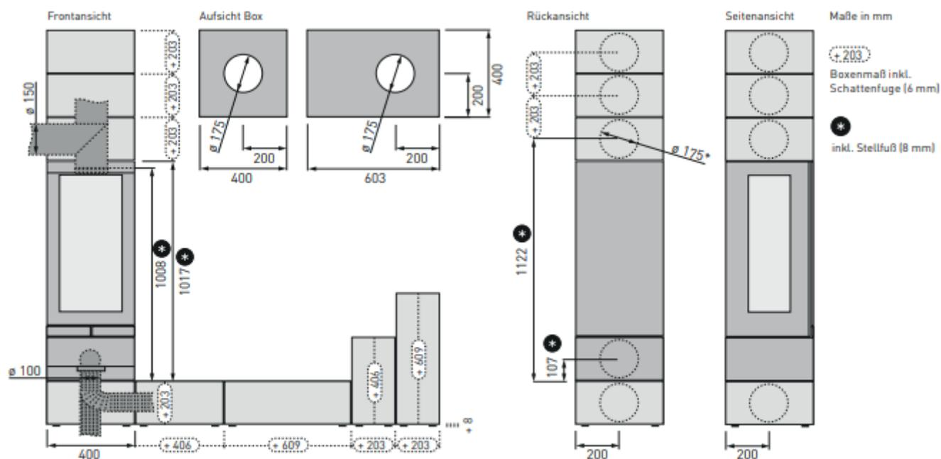
Raumluftunabhängige Einzelraumfeuerstätten mit der Bezeichnung "Elements RLU" in verschiedenen Ausführungsvarianten
