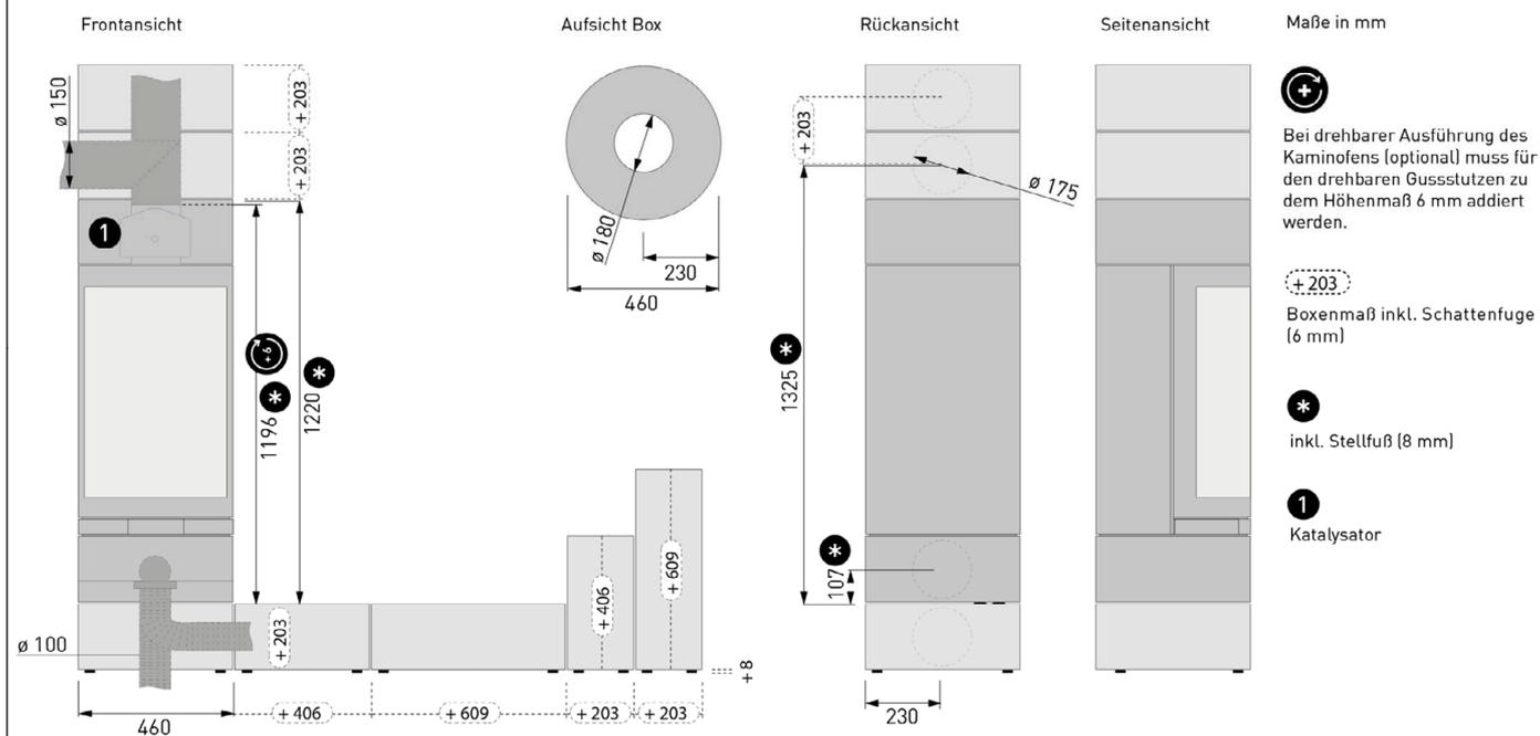
Raumluftunabhängige Einzelraumfeuerstätten mit der Bezeichnung "Elements RLU" in verschiedenen Ausführungsvarianten
