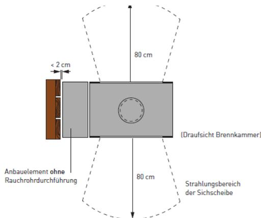
Die seitliche Außenseite von Anbauelementen, in denen keine Rauchrohre durchgeführt werden, kann mit wenigen Millimetern Abstand zu brennbaren Bauteilen oder Wänden installiert werden, da sie sich während des
