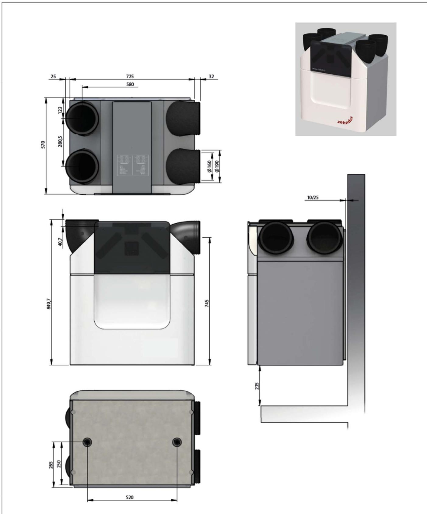
Zentrale Lüftungsgeräte mit Wärmerückgewinnung der Baureihe "ComfoAir Q350"
