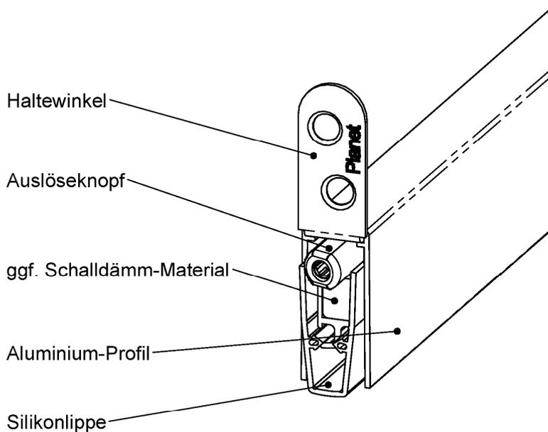
**Prinzipdarstellung Bodendichtung eingefräst, eingelassen, aufgesetzt**
